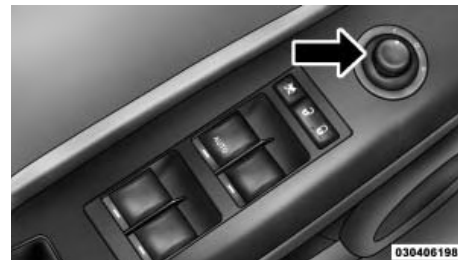
Переключатель электропривода регулировки наружных зеркал заднего вида
