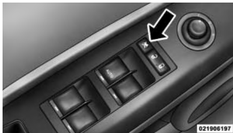
Кнопка блокировки клавиш управления стеклоподъемниками
