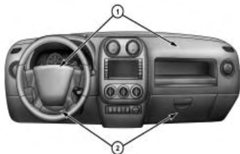
Передние подушки безопасности и накладка для защиты коленей
