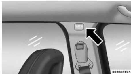
Расположение оконной подушки безопасности
