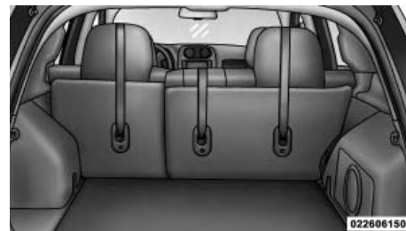
Крепления на заднем сиденье для фиксации монтажных лямок
