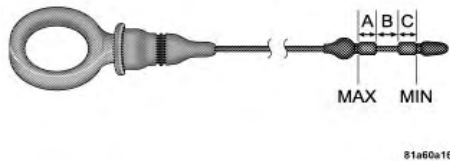
Масляный щуп дизельного двигателя
