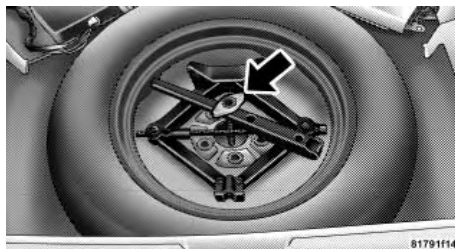
Штатное место расположения запасного колеса и домкрата в автомобиле
