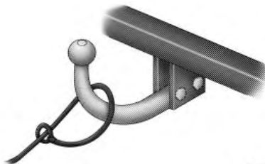
Метод крепления троса к несъемному шаровому крюку с длинной шейкой
