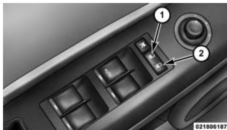
Выключатель системы централизованной блокировки замков дверей, расположенный на водительской двери
