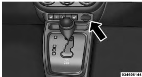
Электрическая розетка напряжением 12 вольт
