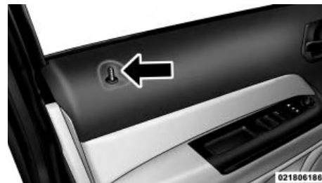
Кнопка блокировки дверного замка
