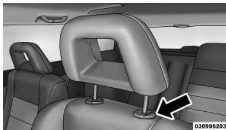
Регулировка подголовников по высоте
