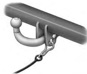
Метод крепления троса к отверстию несъемного шарового крюка
