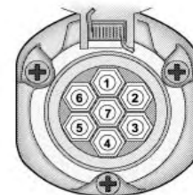
7-контактный электрический разъем
