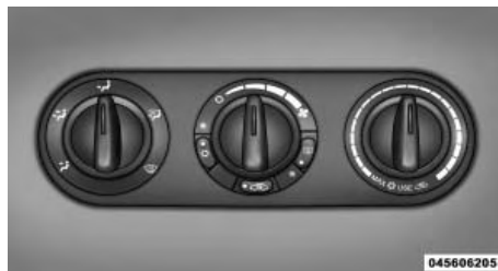
Панель управления микроклиматом
