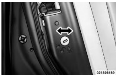
Использование рычажка блокировки замка
