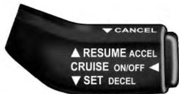
Рычаг управления системой круиз-контроля
