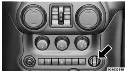
Передняя электрическая розетка
