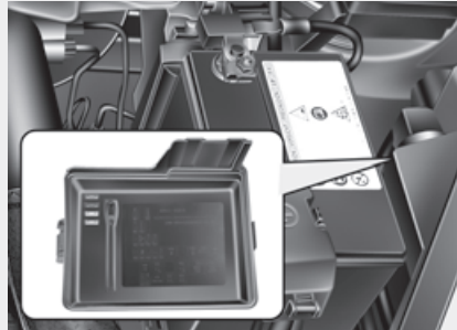
Блок предохранителей двигателя (только ламповый тип защиты фар)
