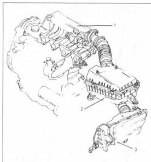
Рис.154. Детали воздушного фильтра дизельного двигателя 1 Впускной коллектор 2 Корпус фильтра 3 Корпус воздухозаборника
