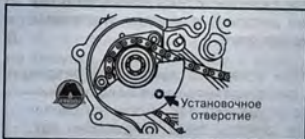
1. Натяжитель приводной цепи ГРМ, 2. Уплотнительное кольцо, 3. Цепь привода ГРМ (газораспределительного механизма), 4. Звездочка привода распределительных валов
