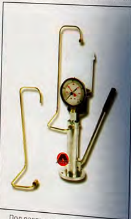
Под распылитель форсунки необходимо подставить мерный сосуд (мензурку).
