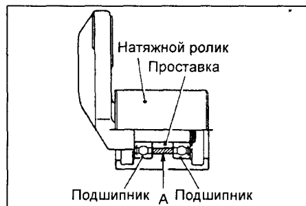
3. Установите подшипники. а) Установите подшипники торцами "А", как показано на рисунке.
