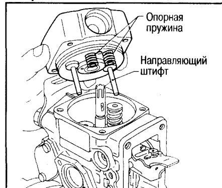
9. Снимите сборку плунжера. Поднимите плунжер вместе с управляющей муфтой, прокладкой, седлом пружины и пружиной плунжера.
