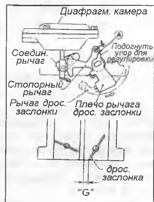
Рис. 125 Регулировка режима холостого хода.
