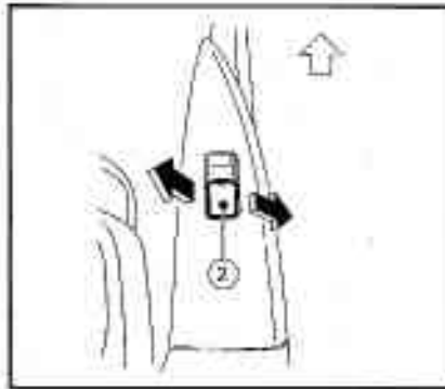
② Выключатель стеклоподъёмника двери переднего пассажира
