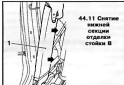
44.11 Снятие нижней секции отделки стойки В
