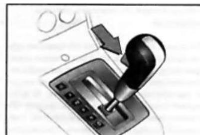
23.2 Рычаг селектора АТ с системой Active Select
