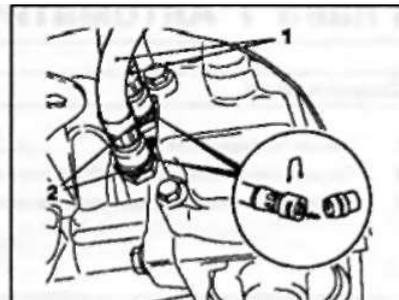
5.11 Штуцерные соединения шлангов (1) охлаждающего тракта ATF
