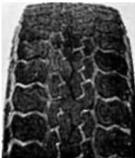
**ЧЕШУЙЧАТЫЙ ИЗНОС ПРОТЕКТОРА, ВЫЗВАННЫЙ НАРУШЕНИЕМ УГЛОВ УСТАНОВКИ КОЛЕС**
