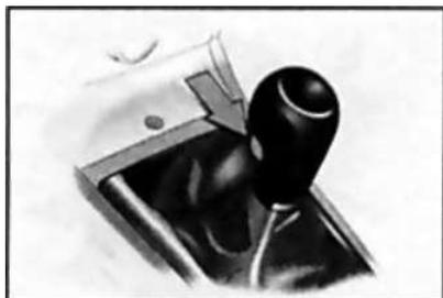
22.1 На рычаге переключения передач РКПП для включения передачи заднего хода необходимо нажать кнопку фиксатора
