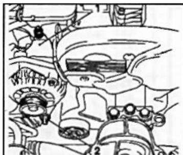
11.32 Снятие кронштейна генератора
