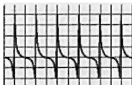
4.39 Типичная осциллограмма сигнала, вырабатываемого индуктивным датчиком
