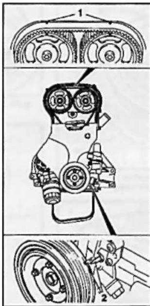
6.17 Поршень первого цилиндра находится в ВМТ такта сжатия если метки (1) и (2) совпадают (двигатели Z20LE(L/R/H))
