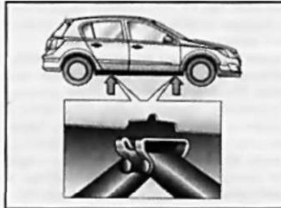
9 Головка домкрата оборудована специальным пазом, обеспечивающим надежность ввода ее в зацепление с ребром жесткости порога в домкратной точке кузова
