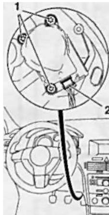
16.4 Крепление электромотора привода заслонки режима циркуляции
