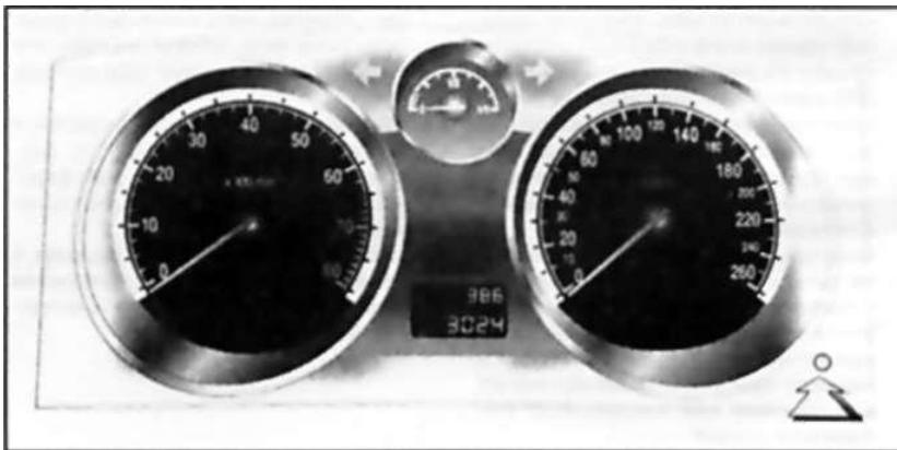
16.1 Схема расположения измерителей в комбинации приборов - стрелкой указана кнопка сброса показаний
