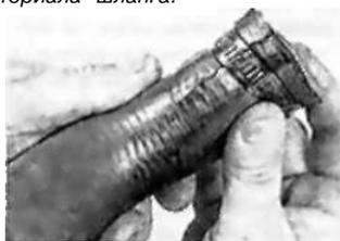
Проверяйте все шланги на наличие вздутий и следов просачивания масла на торцах. Трещины и мелкие разломы в резине легче выявляются при сжимании шланга
