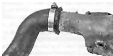
Слишком тугое затягивание хомута с целью более надежной фиксации на штуцере/патрубке отвердевшего шланга не способствует прекращению утечки, а лишь приводит к разрушению материала шланга.
