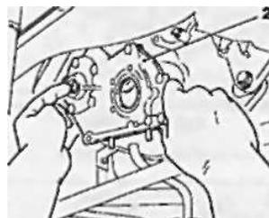
13.33 Установка крышки (2) масляного насоса
