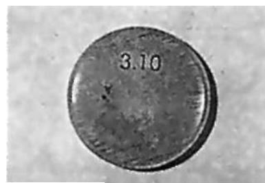
9.32 Толщина регулировочных шайб обычно выбивается на одной из их торцевых поверхностей (шайбы следует устанавливать маркировкой к толкателю)
