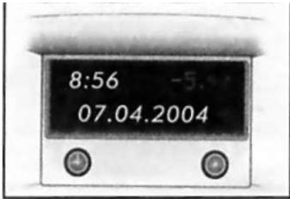
17.53 Индикация трехфункционального дисплея
