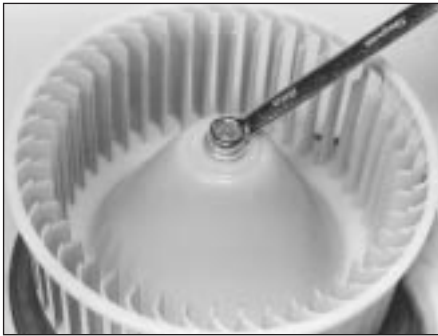
10.20d Remove fan retaining nut . . .
