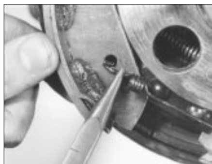
16.5c . . . unhook lower return spring . . .
