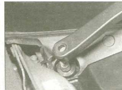
15.3b ... и стяните с оси рычаг
