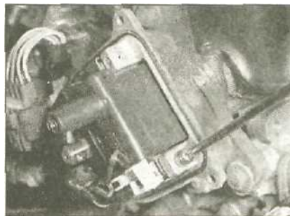
3.5а Ослабьте и извлеките винты крепления...
