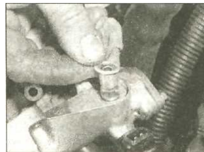
10.41d ...и удалите нижнюю уплотнительную шайбу
