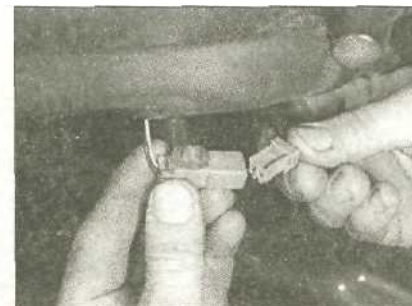
16.9 Отключите проводку от замка крышки багажника
