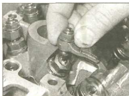
11.17 Сборку коромысел можно поднять из головки цилиндров (после удаления распре-
