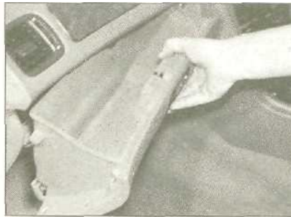
25.5b ... и извлеките бардачок из приборной панели
