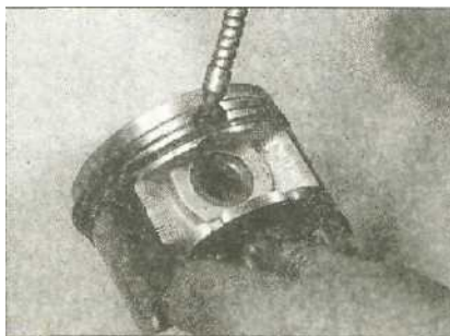
20.10 Смажьте поршневые кольца моторным маслом...
