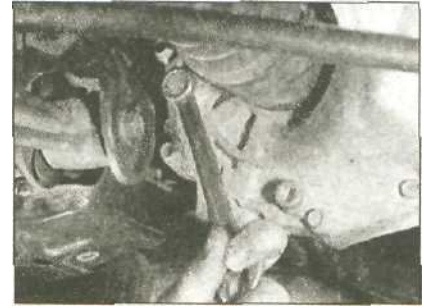
7.2 Снимите пробку заливного/контрольного отверстия в механической коробке передач
