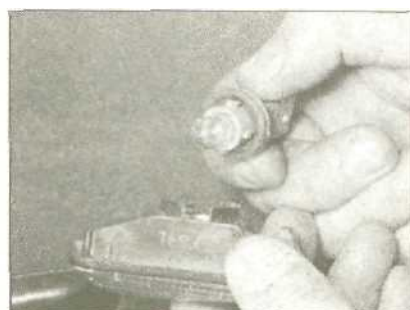
5.21 b ...снимите патрон.
