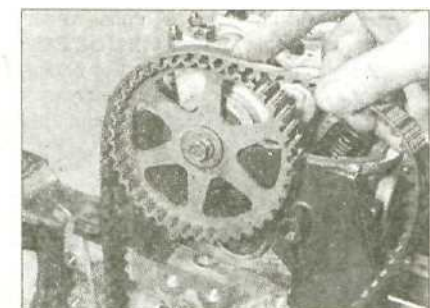
8.8 Установите новый зубчатый ремень, правильно сцепив его с зубцами звездочки
