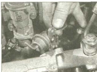
10.61b ...и поднимите корпус регулятора
