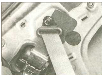
23.8e ... чтобы получить доступ к барабану ремня
