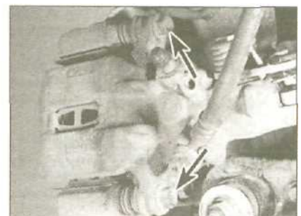
12.6 Снимите болты обоих направляющих штифтов суппорта (отмечены стрелками)
