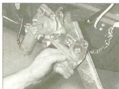
14.11 ... и извлеките стеклоподъемник из двери
