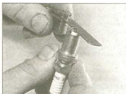
16.11а Определение искрового зазора в свече при помощи плоского щупа...
