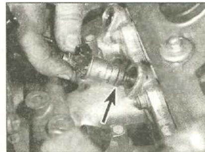
10.43a Если форсунки остались в коллекторе, аккуратно извлеките их вместе с нижними уплотнениями (отмечено стрелкой)
