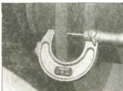
10.3 Измерьте толщину тормозного диска с помощью микрометра
