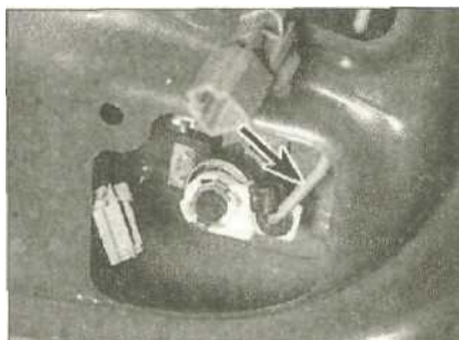
16.8 Отсоедините приводящую тягу от замка крышки багажника
