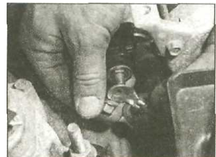
8.4 Снимите чехол, затем ослабьте контргайку и отделите проводку от В-клеммы
