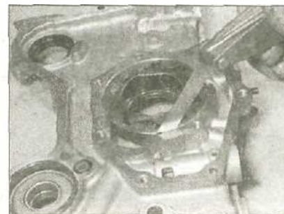
14.10а Измерение зазора между внешним ротором и кожухом насоса
