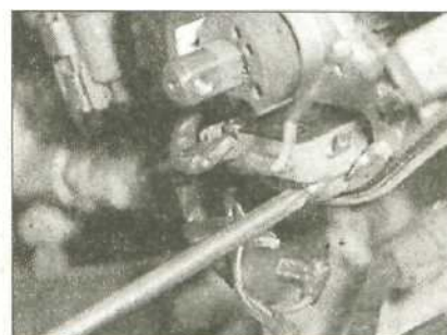
6.5a Ослабьте винты крепления в основании модуля
