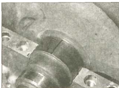
19.10 Положите кусок Plastigauge на коренные шейки, параллельно оси коленвала...
