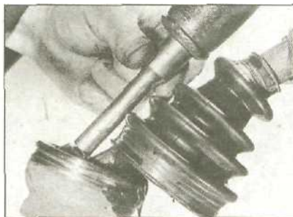
3.10 С помощью мягкого металлического пробойника и киянки сбейте внутренний ШРУС с конца приводного вала
