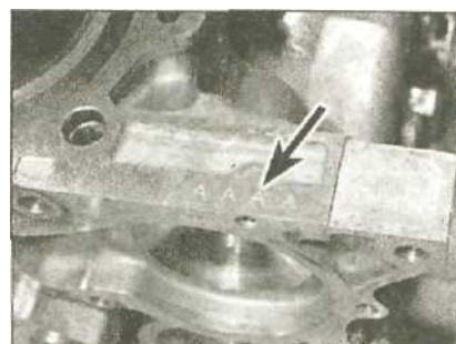
13.11 Метки размерной группы диаметров цилиндров двигателя (отмечены стрелкой)
