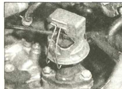
4.2 Местоположение клапана EGR на впускном коллекторе
