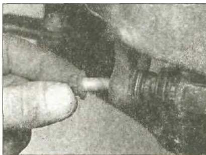
8.2 Снимите болт нижнего направляющего штифта суппорта...
