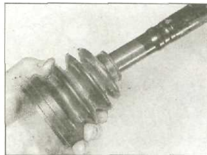
3.16 Установите на приводной вал новые защитные чехлы
