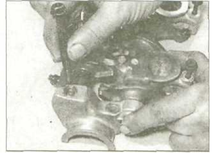
11.8a Открутите болт крепления и снимите крышку подшипника...
