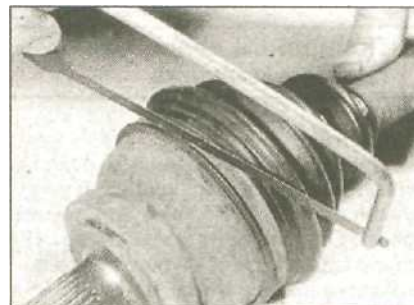
3.2 Если установлены хомуты сварного типа или они заржавели, перережьте их ножовкой (показан внутренний ШРУС)
