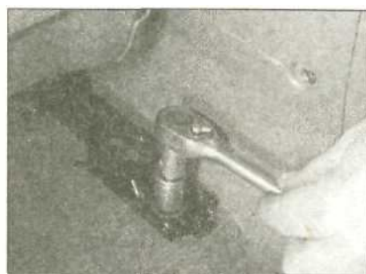
22.3... и открутите задние монтажные болты
