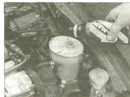
19.5 Доведите до нормы уровень жидкости в питательном бачке насоса рулевого гидроусилителя
