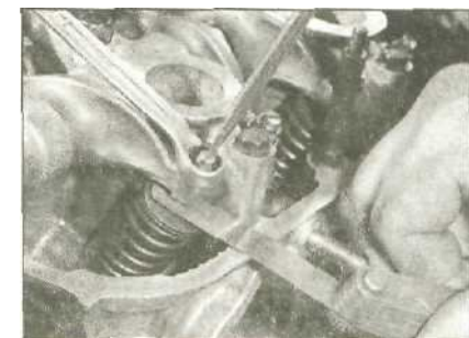
18.4 На двигателях 1.8 и 2.0 л, установите поршень цилиндра №1 в ВМТ на такте сжатия, проверьте и отрегулируйте зазоры всех клапанов этого цилиндра
