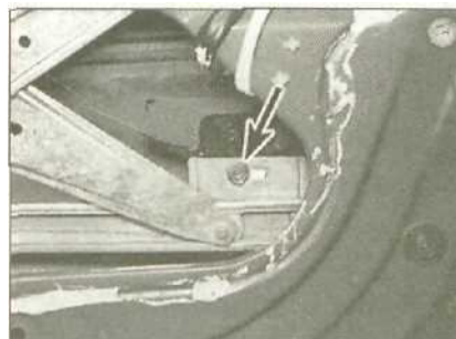
14.3а Переместите направляющую стеклоподъемника назад, чтобы отделить ее от стекла
