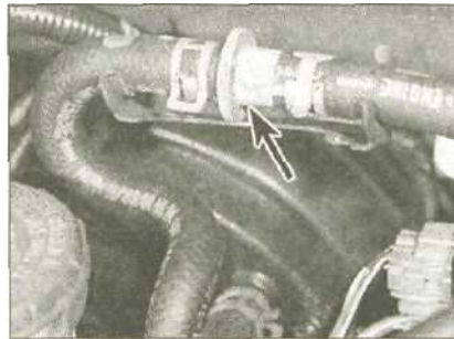
4.1 Контрольный клапан вакуумного усилителя (отмечен стрелкой)
