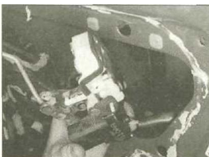
13.28 Снимите замок задней двери ...
