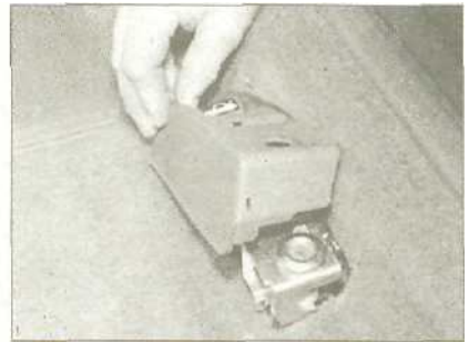
17.2c ... и поднимите кожух сборки с пола
