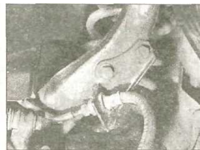
2.3 Кронштейн тормозного шланга на поворотном кулаке
