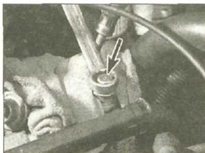
11.4 Удерживая соединительную гайку накидным гаечным ключом, медленно ослабьте дренажный болт и сбросьте давление (отмечена стрелкой)
