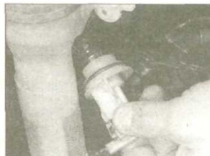
5.17 ...затем открутите патрон переднего указателя поворота...
