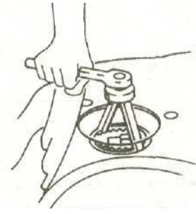
5.7 Снятие датчика с помощью специального инструмента
