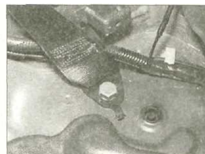
23.8а Передний монтажный болт ремня заднего сиденья
