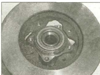
10.12b ...затем поднимите диск со ступицы
