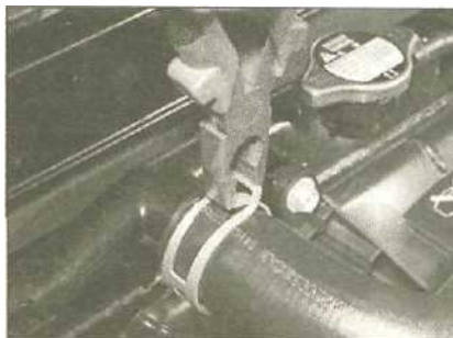
3.3 Отсоедините верхний шланг от радиатора
