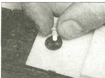
6.32 Снимите патрон сблoка главных переключателей управления стеклоподъемниками
