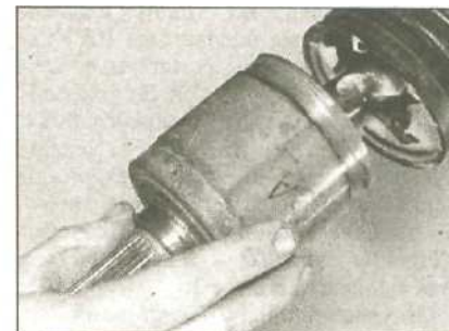
3.4 Нанесите на приводной вал и корпус ШРУСа метки выравнивания, затем извлеките приводной вал
