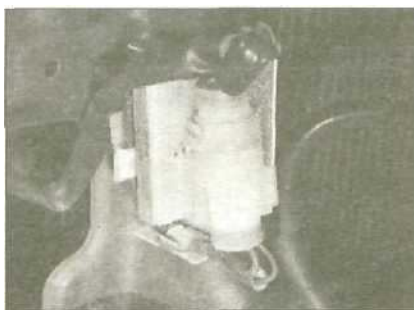
7.16 Резистор тусклого свечения фар (передний бампер удален)
