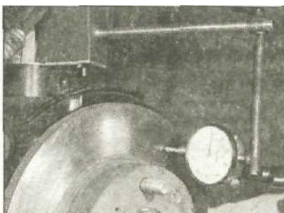
10.4 Измерьте биение тормозного диска с помощью микрометра
