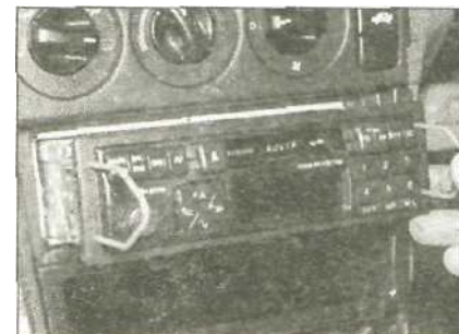
18.5 Снимите автомагнитолу с помощью специальных инструментов
