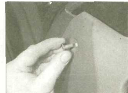
12.4d... затем отожмите отверткой передний фиксатор
