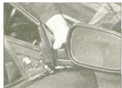
18.8b ... и снимите зеркало с внешней стороны двери
