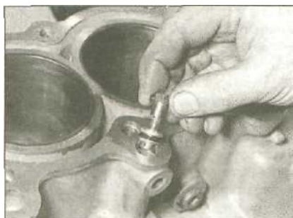
12.12 Используя болт крышки зубчатого ремня, извлеките масляный жиклер из блока цилиндров
