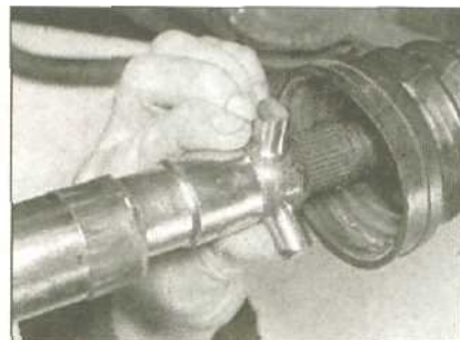
3.23a Совместив сделанные во время снятия метки выравнивания, установите трипоидный ШРУС на пазы приводного вала ...
