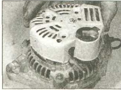
6.3 Снимите заднюю металлическую крышку
