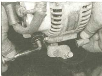
5.9 Снимите нижний монтажный болт генератора и контргайку
