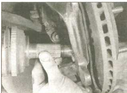
2.7 Возьмитесь за приводной вал одной рукой и выведите шлицевую часть вала из ступицы
