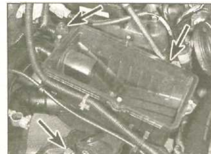
3.6 Открутите монтажные болты воздушного фильтра (отмечены стрелками)
