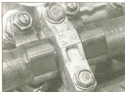
11.13 На всех крышках двигателя 2.3 л имеются идентификационная метка и стрелка
