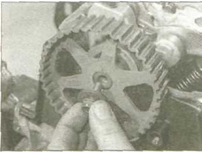
9.6а На двигателях 1.8 и 2.0 л открутите болт крепления, затем снимите звездочку...
