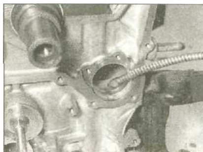
10.11a Смажьте подшипники чистым моторным маслом...
