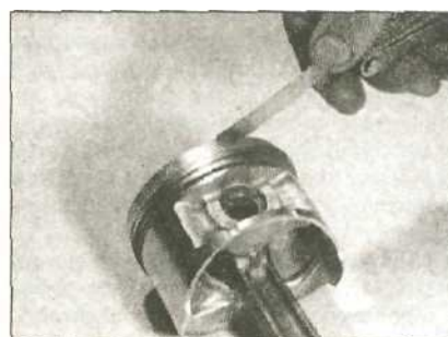
18.10a С помощью щупа проверьте зазор между поршневым кольцом и стенкой канавки
