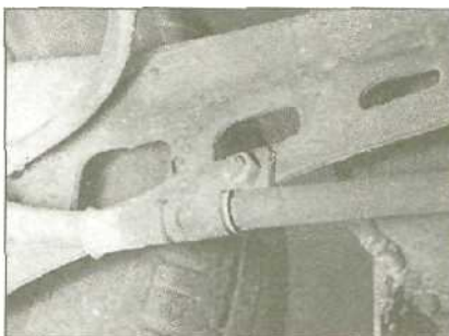
12.2 Опорный кронштейн тросика ручного тормоза на продольном рычаге
