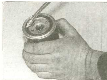
3.11 а Перед установкой фильтра смажьте его кольцевое уплотнение
