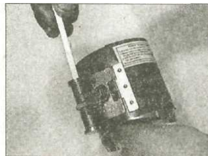
20.11 ...затем правильно распределите разрезы и зажмите кольца специальным инструментом
