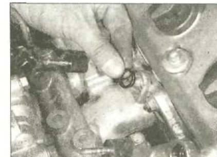
10.43b Когда форсунки будут удалены, достаньте из коллектора изоляционные кольца
