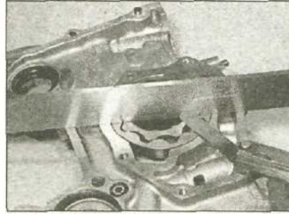
14.10с Измерение осевого люфта ротора
