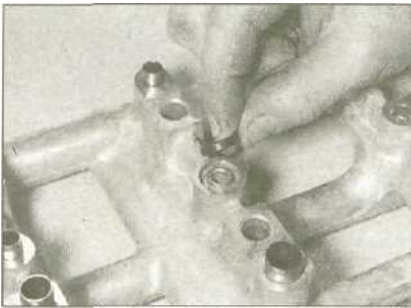
19.22 Вставьте новое кольцевое уплотнение в выемку в центре прижимной рамки крышек коренных подшипников
