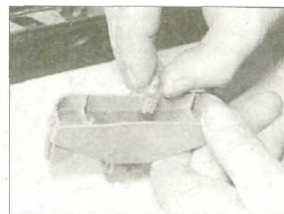
5.28b ...затем достаньте лампу с клинчатым цоколем
