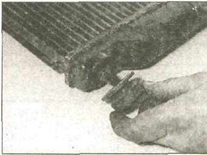
3.8б Снимите резиновые подушки с основания радиатора
