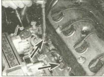
10.40a Открутите винты (отмечены стрелками)...
