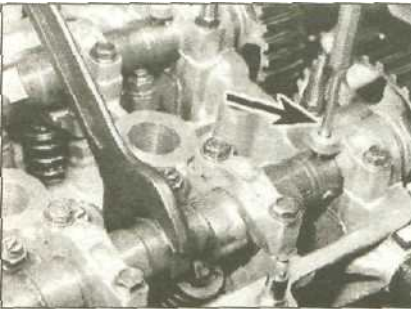
9.10 Верните распредвал в его исходное положение и зафиксируйте его подходящим штифтом (отмечен стрелкой)
