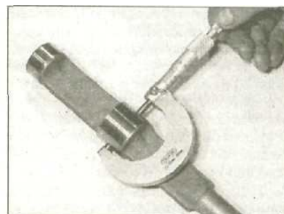
10.6 Измерение диаметра шейки вала блока балансира
