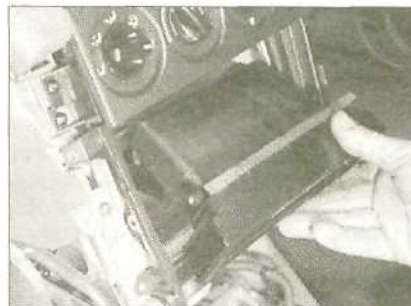
26.6a Снимите ящичек для мелочи ...
