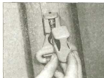
23.4 Снимите отделку регулятора высоты крепления ремня на центральной стойке
