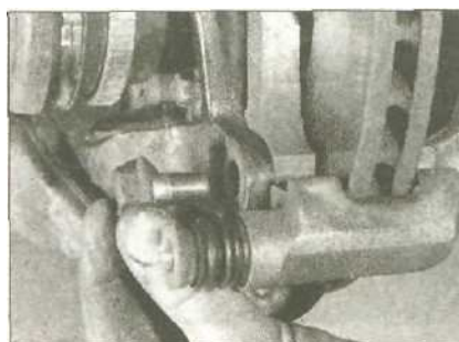
9.5б Если требуется, снимите болты...
