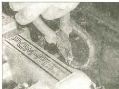
4.8а Отсоедините от впускного коллектора вакуумный шланг тормозного усилителя...
