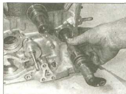
10.11b ...и вставьте передний вал блока балансира на место
