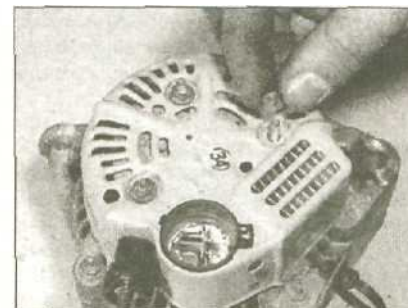
6.1 Открутите гайки крепления задней крышки генератора
