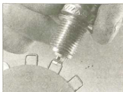
16.11б...или при помощи проволочного шаблона
