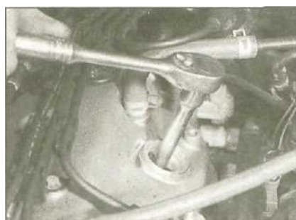
16.5 Для выкручивания свечи зажигания воспользуйтесь ключом с длинной торцевой насадкой
