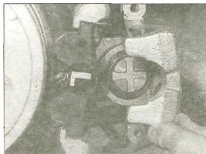
11.3 Поднимите суппорт с диска, обратив внимание на верхнюю пружину, установленную на крышке суппорта
