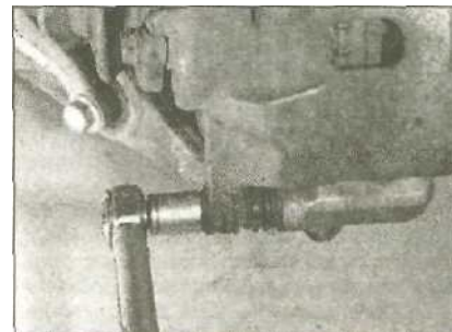
8.13 Зажмите болт нижнего направляющего штифта усилием затяжки, регламентированным Спецификациями
