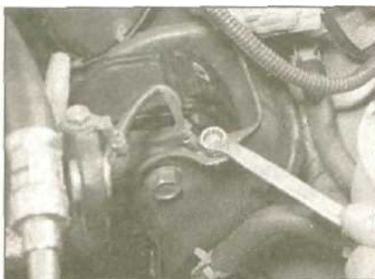
4.10 Открутите болт крепления и отсоедините ремень заземления головки цилиндров (показан двигатель 2.0 л)
