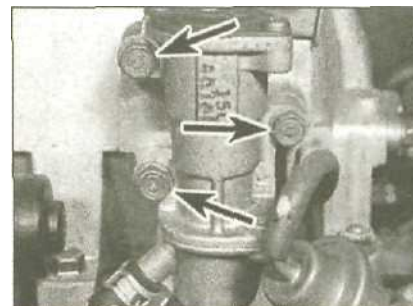
10.11 Зажимные болты термклапана быстрого холостого хода (отмечены стрелками)
