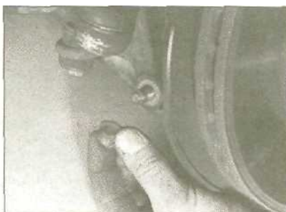
4.6a Открутите гайку ...4.6b ... и извлеките болт, крепящий вилку к нижнему рычагу ...
