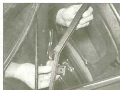
14.18с ... и поднимите канал из двери
