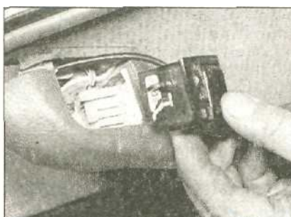
4.31б ...и извлеките выключатель
