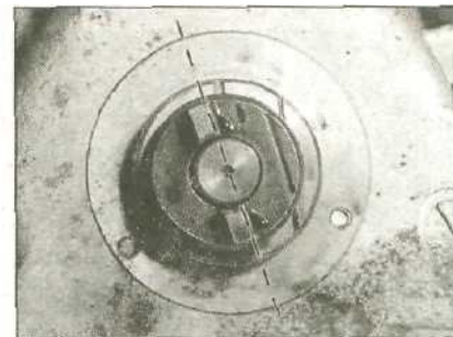
4.10 Обратите внимание, что ведущие выступы привода распределителя несимметричны относительно центра вала
