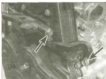
6.2 На двигателях 1.8 и 2.0 л открутите болты (отмечены стрелками) и снимите кронштейн...
