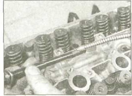
12.23 Слегка смажьте резьбу и головки болтов
