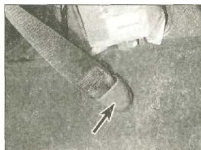
23.3 Болт нижнего анкера ремня переднего сиденья прикрыт накладкой
