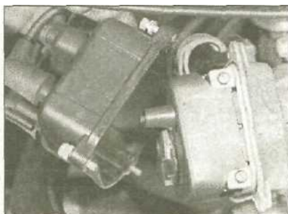
7.3б ...и снимите крышку распределителя
