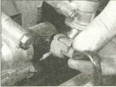
10.39b Отключите электропроводку от клапана IAC
