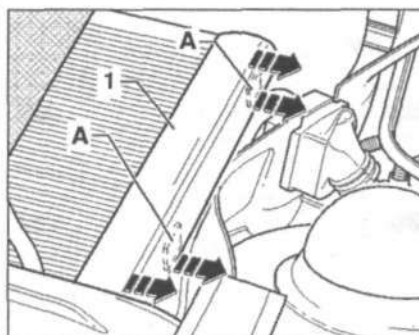
Рис. 12.43. Переместите крышку 1 и отцепите фиксаторы А в направлении стрелок и извлеките фильтрующий элемент.
