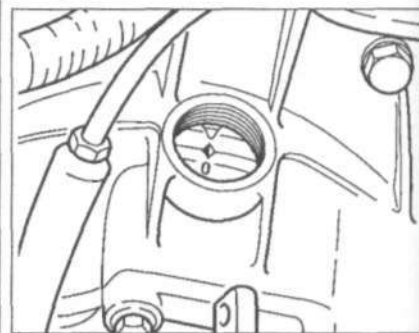
Рис. 5.4. Двигатель установлен: совместите метки ВМТ поршня первого цилиндра на маховике.
