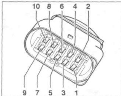
Рис. 7.56. Измерьте сопротивление между контактами 4 и 7.
