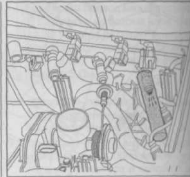
Рис. 3.42д. Установите под проверяемой форсункой и отсоедините разъемы проводки от форсунок.
