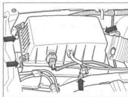
Рис. 2.1. Замена фильтрующего элемента воздушного фильтра на двигателях ADZ, AEY, AFN, AFT, ANB, ANU, AKW, 1F, 1Y.
