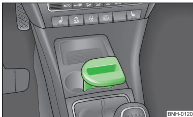
Илл. 54 Передняя часть центральной консоли: подставка для мультимедийных устройств.
