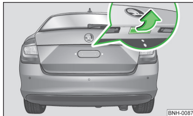
Илл. 15 Отпирание крышки багажного отсека
