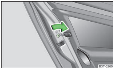
Илл. 11 Блокировка от случайного открывания задних дверей изнутри
