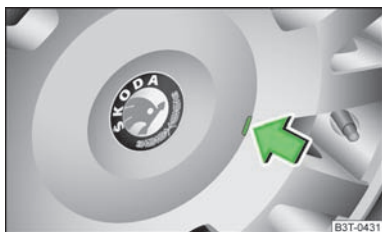
Илл. 171 Отсоединить крышку болтов легкосплавных дисков
