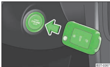
Илл. 115 Аварийный пуск двигателя
