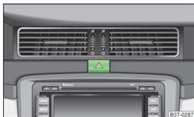
Илл. 37 Передняя панель: выключатель аварийной световой сигнализации
