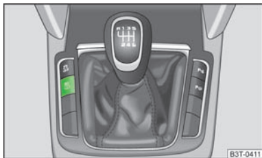
Илл. 172 Клавиша установки контрольных значений давления в шинах
