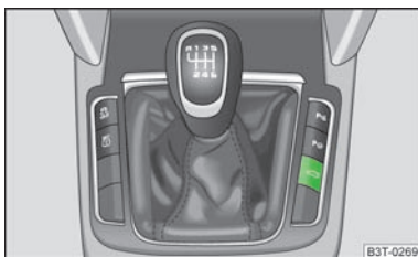
Илл. 23 Управление крышкой багажного отсека - клавиша на центральной консоли
