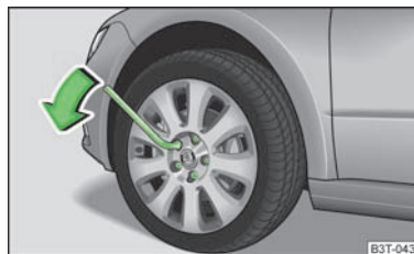
Илл. 176 Замена колеса: откручивание колёсных болтов
