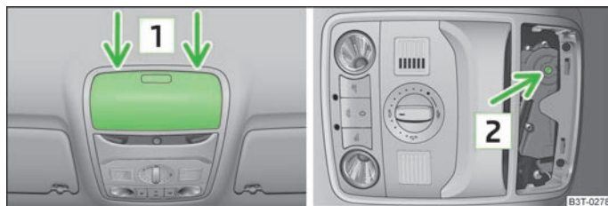
Илл. 28 Фрагмент потолка / Место установки ключа
