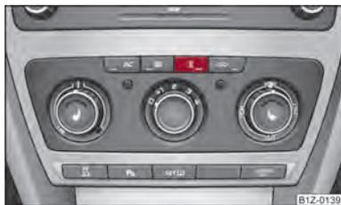
Илл. 96 Клавиша для прямого включения/выключения дополнительного отопителя (автономного отопления и вентиляции) на панели правления климатической установки
