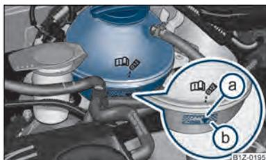
Илл. 152 Моторный отсек: Расширительный бачок ОЖ
