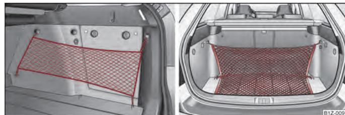
Илл. 54 Багажная сетка: продольный отсек/разделение багажного отсека
