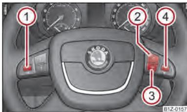
Илл. 114 Многофункциональное рулевое колесо: клавиши управления телефоном
