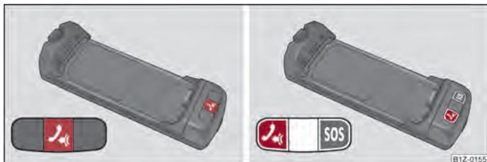
Илл. 112 Иллюстрация: адаптер с одной клавишей / адаптер с двумя клавишами
