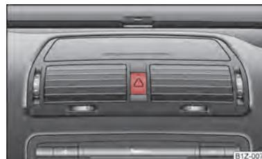
Илл. 29 Передняя панель: Выключатель аварийной световой сигнализации
