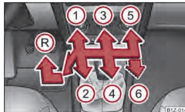
Илл. 100 Схема переключения: 5-ступенчатая или 6-ступенчатая коробка передач
