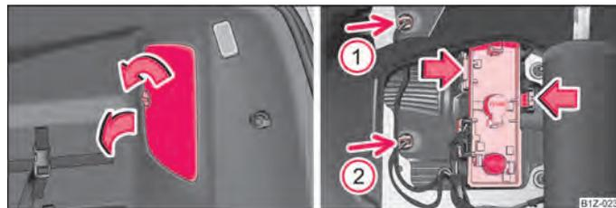
Илл. 189 Багажный отсек: Крышка колодки ламп / Снятие колодки ламп
