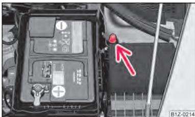
Илл. 172 Пуск двигателя автомобиля с системой Старт-стоп от внешнего источника
