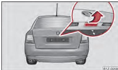
Илл. 15 Ручка крышки багажного отсека
