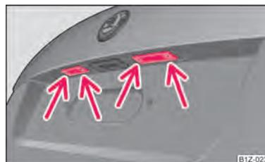
Илл. 188 Снятие лампы фонаря освещения номерного знака
