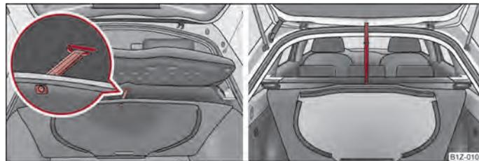
Илл. 57 Багажный отсек: крепление напольного покрытия Octavia / Combi
