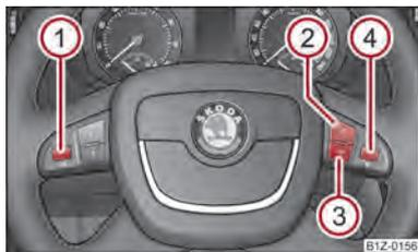
Илл. 113 Многофункциональное рулевое колесо: клавиши управления телефоном
