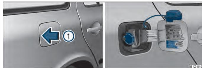
Илл. 147 Правая задняя часть автомобиля: Открывание лючка заливной горловины / Лючок заливной горловины с вывинченной пробкой
