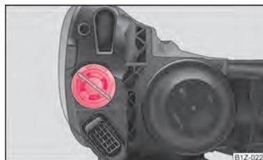
Илл. 182 Снятие лампы накаливания переднего указателя поворота
