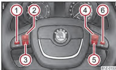
Илл. 110 Многофункциональное рулевое колесо: клавиши
