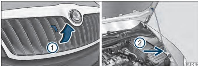
Илл. 149 Решётка радиатора: Стопорный рычаг/фиксация капота с помощью опоры
