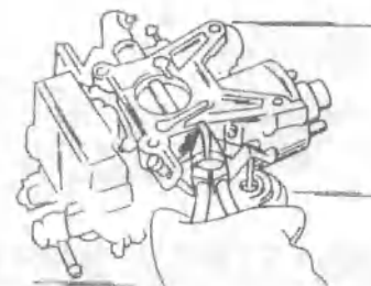
3.24 Подгибание упорного язычка для регулировки открытия дроссельной заслонки (тип карбюратора V)
