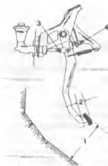
5.1 Отдельные элементы для регулировки высоты педали сцепления
