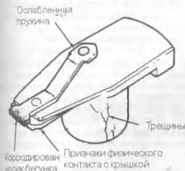
14.11d Бегунок следует проверять на износ и коррозию, как показано на рисунке (если есть сомнения относительно его состояния, купите новый)
