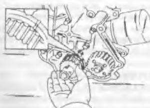
8.20 Установка зубчатого колеса распреде- ла. Метка на зубчатом колесе и корпусе масляно- го насоса должны совпадать
