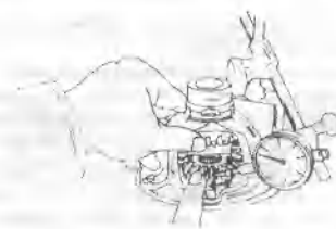
4.3 Проверка зазора между зубцами сателлитов дифференциала
