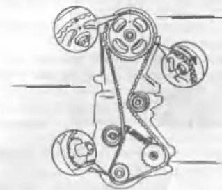
4.88 Установка зубчатого ремня. Следить за управляющими метками и стрелкой на зубчатом ремне
