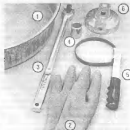
6.1 Эти инструменты необходимы для проведения смены двигательного масла и масляного фильтра
