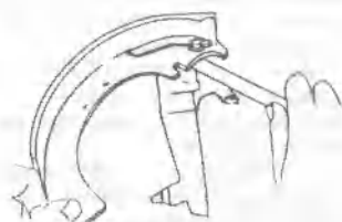
4.22 Измерение зазора между рычагом ручного тормоза и тормозной колодкой с помощью щупа. Отрегулировать зазор с помощью компенсационных шайб, как показано на рисунке 4.24А
