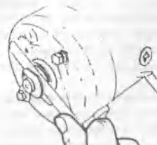
11.9 Измерение осевого люфта вала якоря перед разборкой стартера
