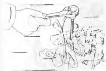
4.6 Ослабление крепления распределителя зажигания с помощью торцевой головки, удлинителя и храпового привода
