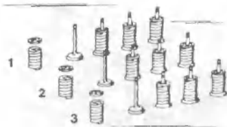
4.30 Клапаны и пружины клапанов могут быть разложены следующим образом
