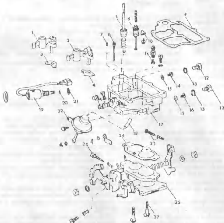
2.16В Монтажная схема корпуса карбюратора и относящиеся к нему детали (тип К)
