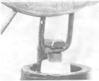
13.4a Фирмы-изготовители свечей зажигания рекомендуют использовать для определения величины свечного зазора измерители проволоочного типа - если измерительный элемент не проскальзывает между электродами свечи с легким сопротивлением, значит, требуется регулировка зазора
