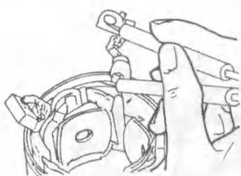
11.21 Проверка катушек возбуждения на соединении с массой
