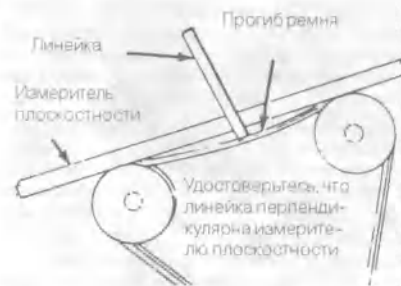
10.4 Измерение величины прогиба приводного ремня с помощью линейки и измерителя плоскостности
