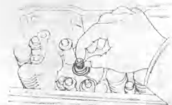
4.64 Установка маслоотражательных колпачков
