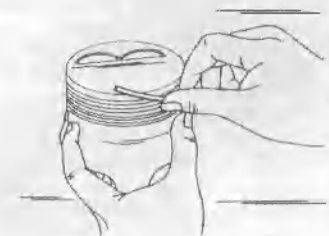
5.23 Установка частей и расширителя маслоъемного кольца
