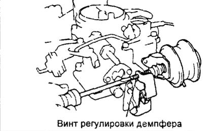
Винт регулировки демпфера
