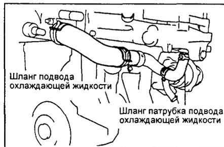
Шланг подвода охлаждающей жидкости
