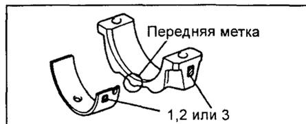
а) С помощью кернера или цифрового клейма поставьте монтажные метки на сопрягаемых поверхностях шатуна и крышки для правильной последующей сборки.
