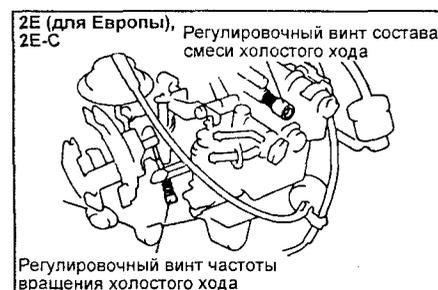
2E (для Европы), Регулировочный винт состава смеси холостого хода
