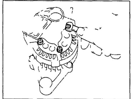
2. Снимите щеткодержатель и электронный регулятор напряжения.
