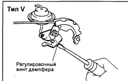
6. Проверьте и отрегулируйте повышенную частоту вращения холостого хода (см. главу "Механизмы двигателя").
