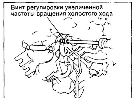
Винт регулировки увеличенной частоты вращения холостого хода
