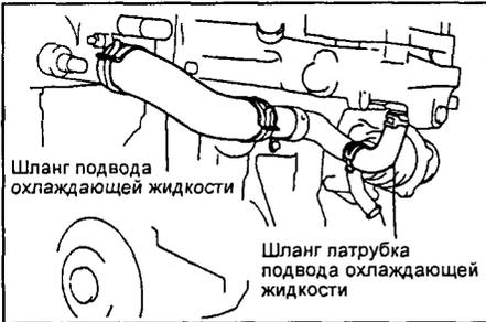
5. Снимите жидкостной насос.
