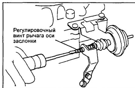
7. Проверьте и отрегулируйте ход поршня ускорительного насоса.
