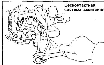
2. Снимите водоотводящий патрубок. а) Отсоедините водяной шланг.
