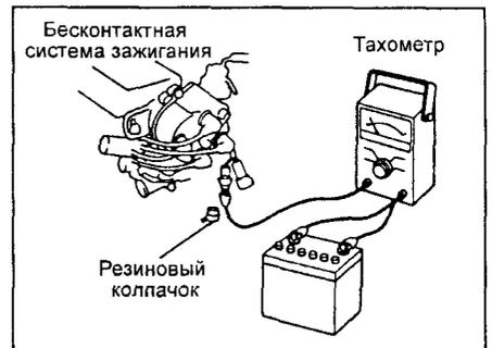
2. Прогрейте двигатель до нормальной рабочей температуры.
