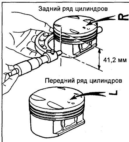
Поршень фирмы "Mahle" (1MZ-FE).
