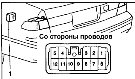
1 - Блок системы обнаружения неисправности ламп задних фонарей.
