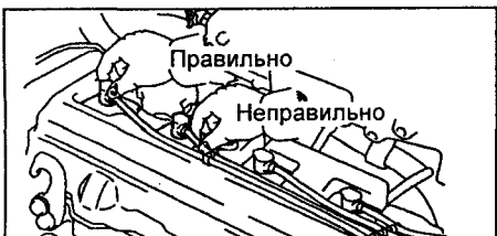
Разводка высоковольтных проводов (1MZ-FE (MXV20)).
