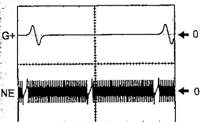
RSC, RSO - E1 (4A-FE, 5A-FE с 1992 г), ISCC, ISCO - E1 (3S-FE, 4S-FE) Цена деления: X - 1 мсек, Y - 5 В. Режим: холостой ход, кондиционер выключен.
