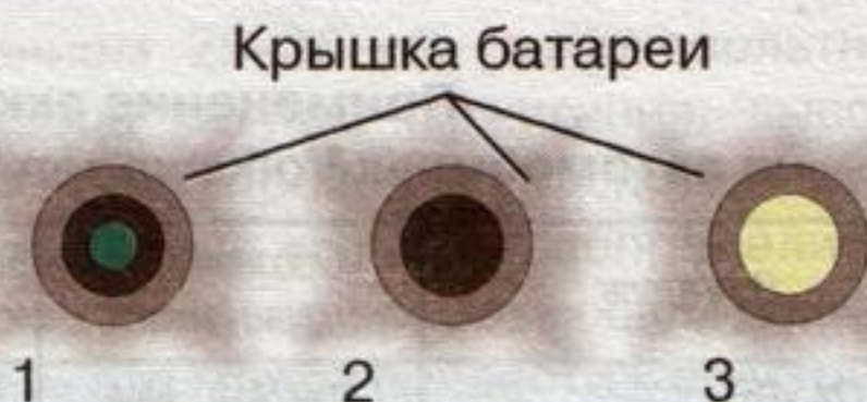
Рис. 1. Показания индикатора плотности электролита: 1 – темный индикатор с зеленой точкой – батарея заряжена; 2 – темный индикатор без зеленой точки – батарея разряжена; 3 – прозрачный или светло-желтый индикатор – низкий уровень электролита
