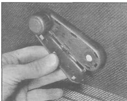
Рис. 14.4, а. Снятие накладки ручки стеклоподъемника...
