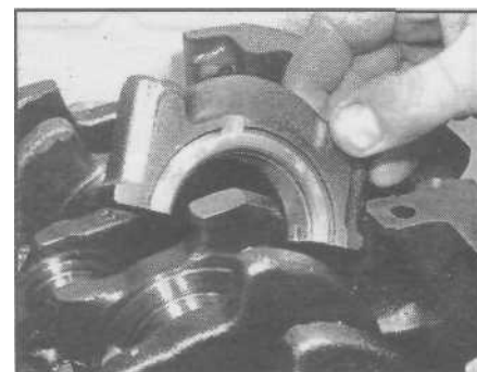
Рис. 30.5. Установка крышек коренных подшипников
