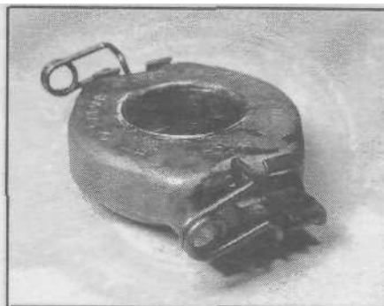
Рис. 7.2, б. Выжимной подшипник и его фиксаторы
