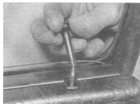
Рис. 14.1. Отворачивание кнопки блокировки двери
