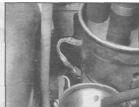
Рис. 6.2. Шина заземления транзисторного распределителя зажигания (от экрана)
