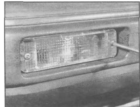
Рис. 8.4. Снятие рассеивателя переднего указателя поворота
