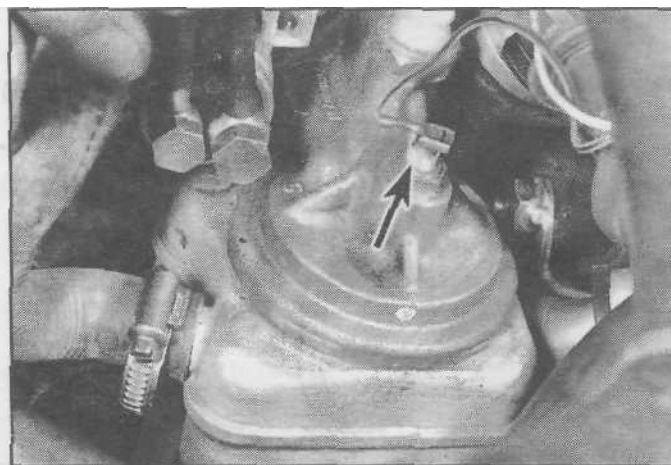
Рис. 5.39. Датчик указателя температуры масла [показан стрелкой]
