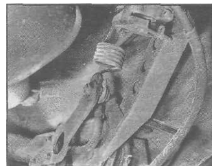
Рис. 9.3. Узел регулятора давления тормозов с кронштейном пружины
