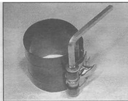
Кондуктор для установки поршневых колец
