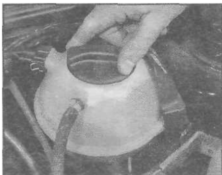
Рис. 2.2. Снятие крышки расширительного бачка
