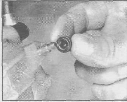
Рис. 12.23. Установите защитные колпачки НА ниппели для выпуска воздуха
