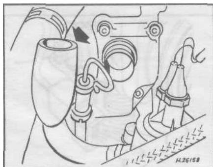
Рис. 2.2. Отсоединение шланга вентилиции картера
