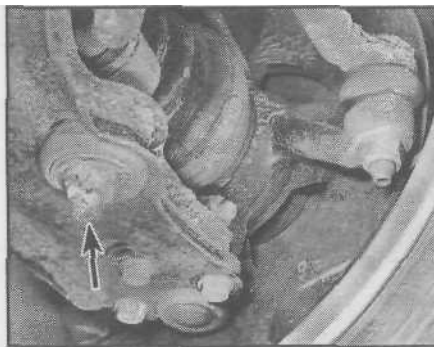
Рис. 4.2. Гайка болта с проушиной стабилизатора поперечной устойчивости (показана стрелкой)
