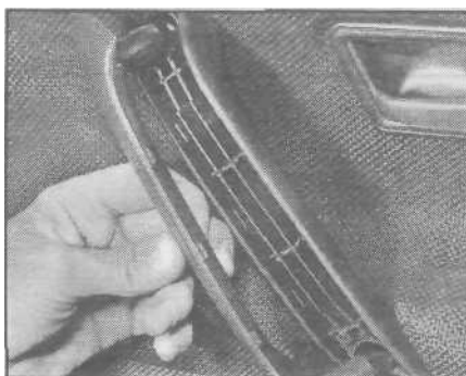
Рис. 14.3, а. Снятие накладки с ручки подлокотника
