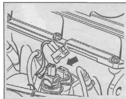
Рис. 17.34. Отсоединение провода датчика температуры
