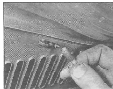
Рис. 6.3. Отсоедините трубки омывателя ветрового стекла от капота
