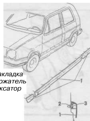
Рис. 27.11. Детали боковой защитной наклейки
