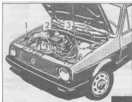
Расположение идентификационных номеров в моторном отсеке 1 Пластина идентификации автомобиля 2 Номер двигателя 3 Номер шасси
