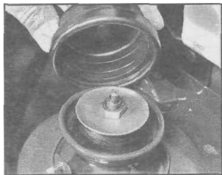
Рис. 8.4. Снятие крышки верхней опоры стойки задней подвески
