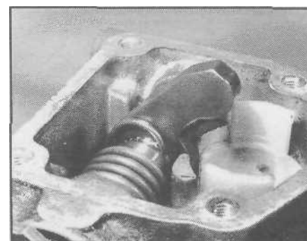
Рис. 7.17. Снятие стопорных колец выжимного рычага сцепления
