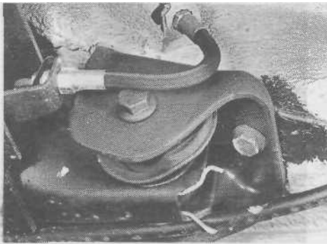
Рис. 9.7. Положение головок шарнирных болтов продольных рычагов
