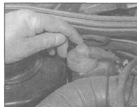
Рис. 5.4. Проверьте действие датчика уровня тормозной жидкости
