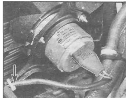
Рис. 3.15. Закрепите провода вентилятора при помощи пластмассового держателя
