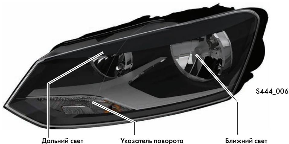
Фары Polo 2010 могут быть сняты с помощью бортового комплекта инструментов. Это необходимо, поскольку замена ламп возможна только при снятой фаре.
