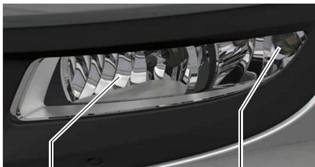
Противотуманные фары с функцией адаптивного освещения (в качестве опции)
