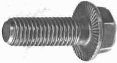
Рифленый болт -А- (M10x30) Момент затяжки 70 Нм.
