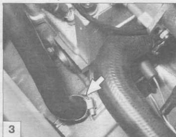
3 Соединение шланга вентиляции картера со штуцером на двигателе.
