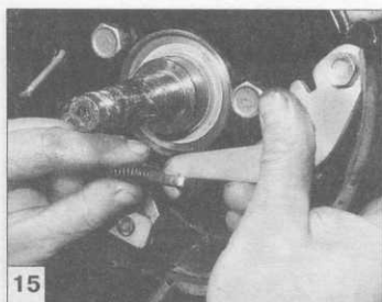
15 Снимите заднюю колодку, отсоединив наконечник троса стояночного тормоза от рычага ручного привода колодок.
