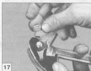
17 Обратите внимание: под гайкой установлена пружинная шайба.
