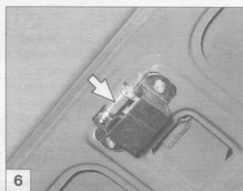
6 Замок задней двери (смазка ФИОЛ-1).
