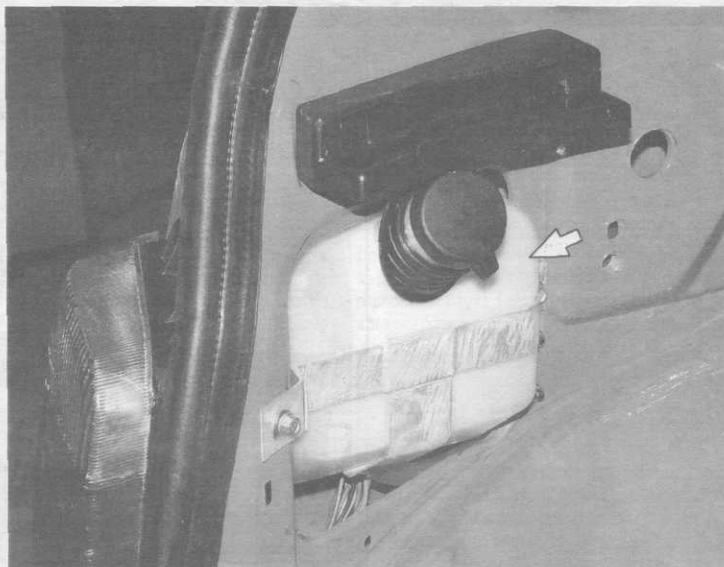
Бачок омывателя стекла задней двери расположен в левой задней части багажного отделения.
