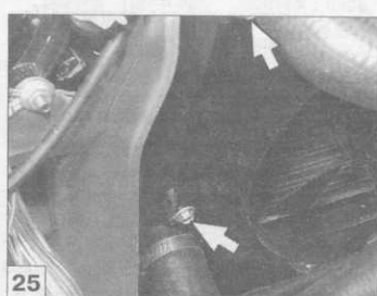
25 ...кожуха вентилятора системы охлаждения (три болта и одна гайка; ключ «на 8»)...
