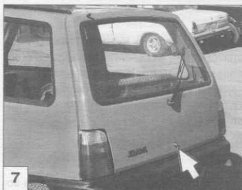
7 Цилиндр замка задней двери (смазка ВТВ-1 в аэрозольной упаковке).
