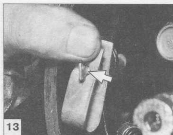
13 ...поверните стойки обеих колодок и снимите пружины.
