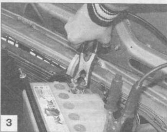
Специальные провода для пуска двигателя от внешнего источника тока
