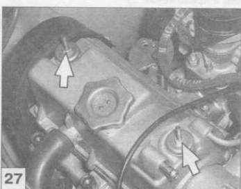
27 ...крышки головки блока цилиндров (ключ «на 10»)...
