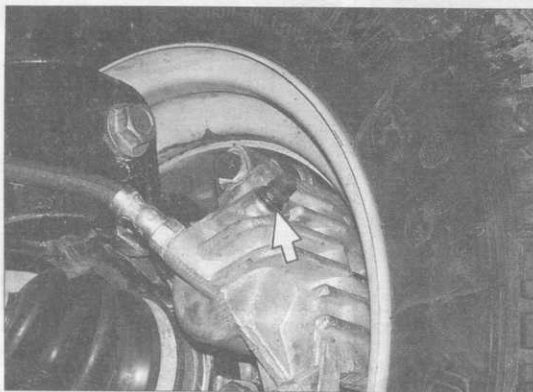
Клапан выпуска воздуха тормозного механизма переднего колеса
