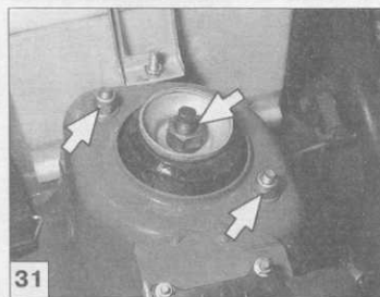
31 ...стойки передней подвески к кузову и штока амортизатора к ее верхней опоре (ключи «на 13» и «на 19»)...
