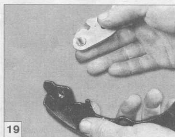
19 Снимите рычаг ручного привода с колодки.
