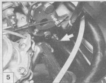
5 Шланг отвода жидкости подогрева впускной трубы.
