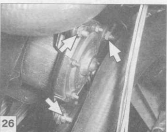
26 ...электродвигателя вентилятора системы охлаждения к кожуху вентилятора (ключ «на 10»)...
