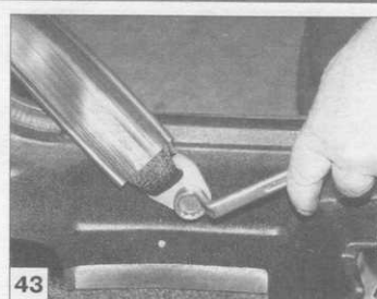
43 ...верхних и нижних креплений ремней безопасности, а также их замков (ключ «на 17»)...
