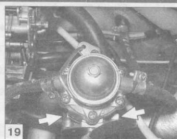
19 ...топливного насоса (ключ «на 10»; корпус воздушного фильтра снят для наглядности)...
