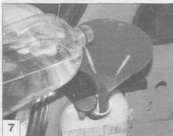
Бачок омывателя стекла задней двери расположен в левой задней части багажного отделения.
