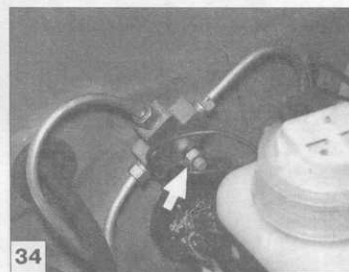
34 ...соединительного тройника тормозных трубок к шпильке кузова (ключ «на 10»)...
