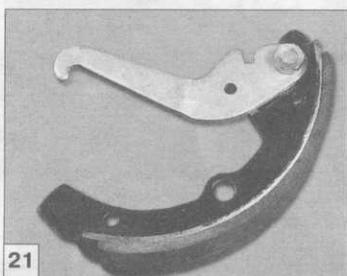
21 Установите рычаг ручного привода на новую заднюю колодку в порядке, обратном снятию.
