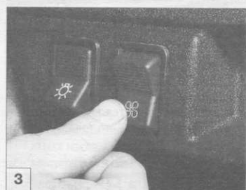
Органы управления вентиляцией и отоплением салона: 1 – переключатель электровентилятора отопителя; 2 – поворотные дефлекторы; 3 – рычаг управления крышкой люка воздухопритока; 4 – рычаг управления краном отопителя
