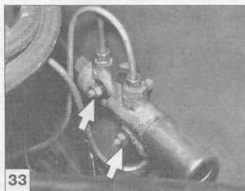
33 ...регулятора давления гидропривода тормозов (ключ «на 13»)...
