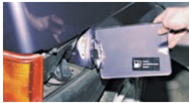
...и снимаем крышку лючка бензобака.
