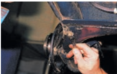
Ключом «на 10» отворачиваем гайку скобы крепления оболочки троса к балке задней подвески.
