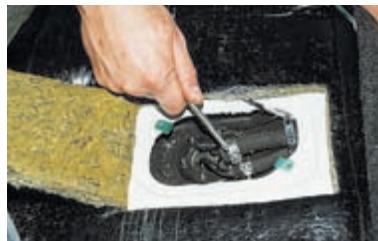
Крестообразной отверткой ослабляем хомуты крепления шлангов подвода и слива топлива к трубкам.
