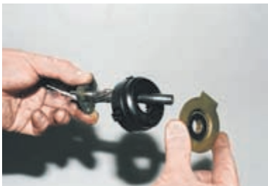
...и снимаем опору вала и шестерню с внутренними зубьями. Сборку стартера проводим в обратном порядке, при этом...
