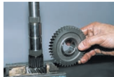
Снимаем ведомую шестерню I передачи.
