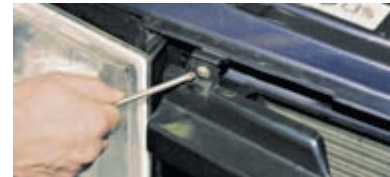
Крестообразной отверткой отворачиваем два самореза.
