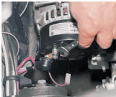
Ключом «на 10» отворачиваем гайку крепления наконечников проводов к выводу «В+»...
