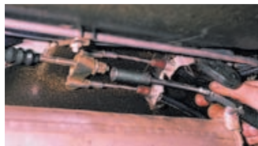
Высокой головкой «на 13» отворачиваем контргайку и регулировочную гайку тяги.
