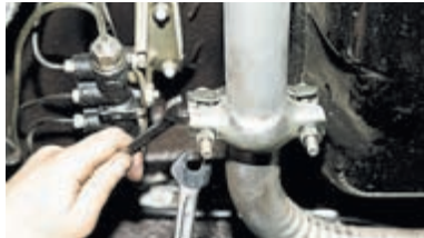
...двумя ключами «на 13» отворачиваем два болта хомута.
