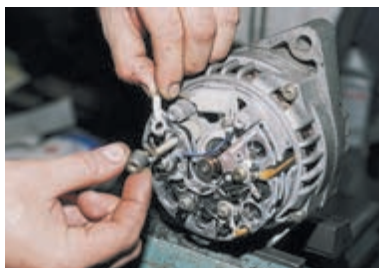
...снимаем втулку и провод конденсатора.
