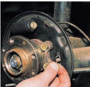
Для замены направляющей пружины колодки извлекаем пружину из отверстия щита тормозного механизма.
