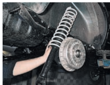
Вынимаем амортизатор вместе с пружиной.
