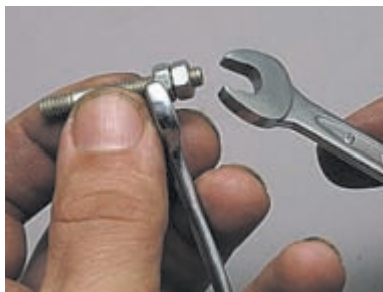
Чтобы гайки не проворачивались на шпильке, двумя ключами аккуратно законtringуем их, стараясь не сорвать резьбу.
