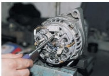
Если нужно заменить конденсатор, то, отвернув крестообразной отверткой винт,
