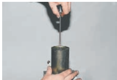
...опускаем корпус на заднюю крышку. Смазываем шестерни планетарного редуктора смазкой ШРУС-4.
