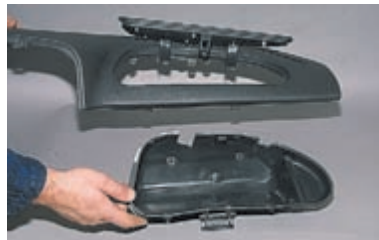
...и отсоединяем корпус верхнего вещевого ящика от накладки панели приборов.
