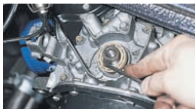
Поддеваем отверткой сальник и извлекаем его из крышки масляного насоса.
