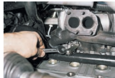
Ключом «на 13» отворачиваем верхнюю и ослабляем нижнюю гайки крепления кронштейна подводящей трубы насоса охлаждающей жидкости...
