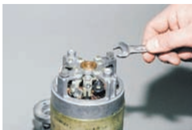
Ключом «на 10» отворачиваем два стяжных болта.
