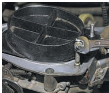
Заворачиваем шпильку в крышку до упора, вращая ее ключом за верхнюю гайку.
