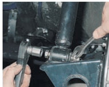
Головкой и ключом «на 19» отворачиваем болт крепления амортизатора к балке.
