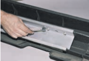
Ключом «на 10» отворачиваем восемь болтов крепления балки к облицовке бампера...
