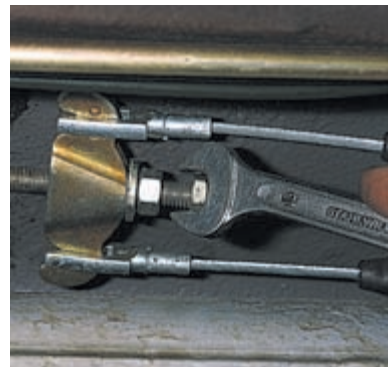
Вращая регулировочную гайку по часовой стрелке, натягиваем трос.
