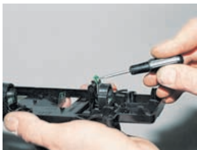
При необходимости замены контактных дорожек поддеваем отверткой...
