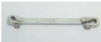
Ключ для штуцеров тормозных трубок
