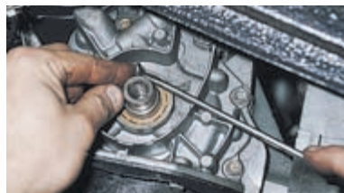
Чтобы не потерять шпонку, извлекаем ее из паза коленчатого вала.
