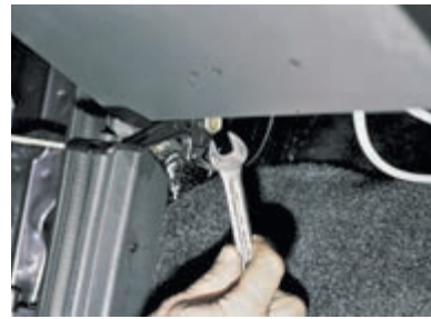
Для снятия рукоятки привода замка капота ключом «на 13» отворачиваем болт...
