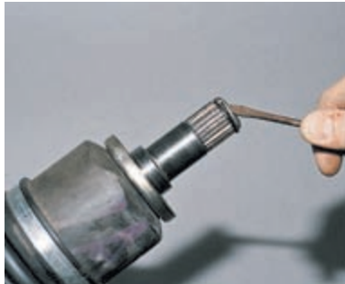
Поддеваем отверткой стопорное кольцо, которым привод фиксируется в коробке передач,
