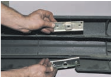
Снимаем планки крепления балки. Собираем и устанавливаем бампер в обратной последовательности.
