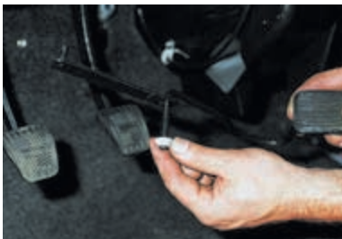
Вынимаем педаль привода дроссельной заслонки.
