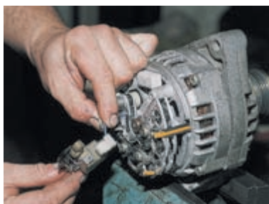
Отсоединяем провод и снимаем регулятор напряжения с щеткодержателем.
