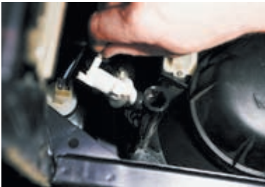
...нажимаем фиксатор, поворачиваем против часовой стрелки и вынимаем цилиндр гидрокорректора из фары.
