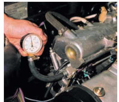
При исправном регуляторе давление топлива должно вырасти на 0,2–0,7 бар (20–70 кПа).
