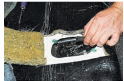
...и сдвигаем с трубок шланги.
