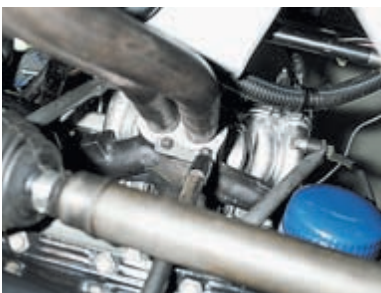
Головкой «на 13» отворачиваем четыре гайки крепления приемной трубы к выпускному коллектору.
