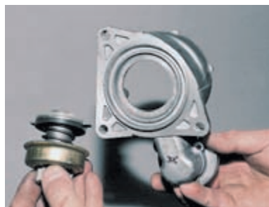
Вынимаем привод с обгонной муфтой («бендикс») из передней крышки.
