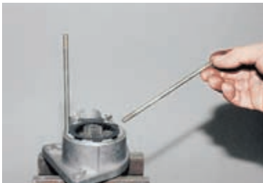
Выворачиваем из передней крышки шпильки.
