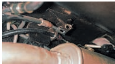
Вынимаем наконечник оболочки троса из кронштейна.
