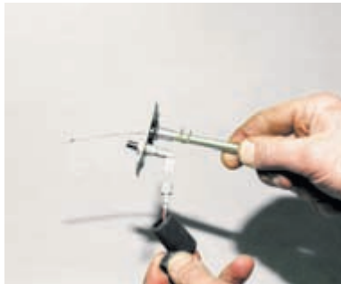
...отсоединяем клемму выключателя.
