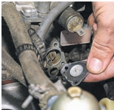
Снимаем поврежденную диафрагму.
