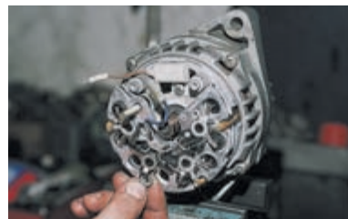
На винты крепления концов обмоток статора надеты изолирующие шайбы.
