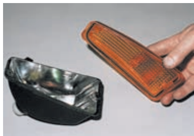
...и снимаем рассеиватель. Для замены разбитого стекла фары...
