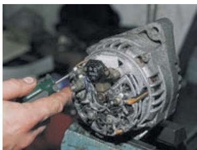
Крестообразной отверткой отворачиваем два винта...
