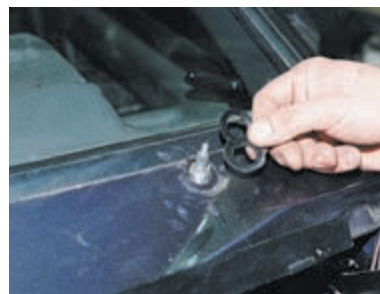
Снимаем пластиковую и резиновую шайбы.
