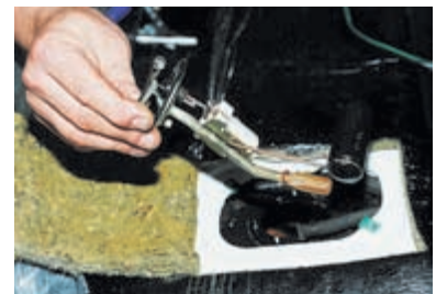
Осторожно вынимаем бензоприемник с датчиком уровня топлива из бака, стараясь не повредить поплавков.
