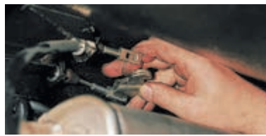
Разъединяем уравниватель и наконечник троса.
