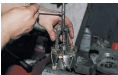
Подшипник спрессовываем съемником.
