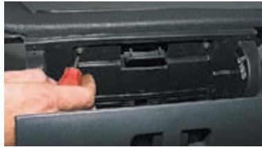
...крестообразной отверткой отворачиваем два самореза в верхней его части...
