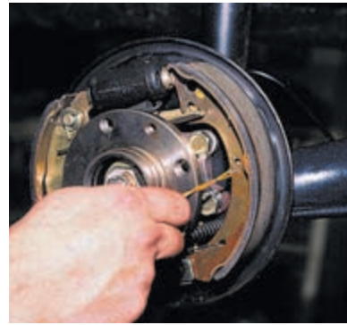
Натягивая пружину, вставляем ее конец в отверстие колодки.
