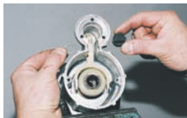
Из передней крышки извлекаем резиновую заглушку и шайбу.
