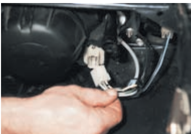
Отсоединяем разъем от фары... ...и от указателя поворота.
