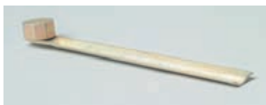
Ключ с восьмигранником «на 17» для регулировки рулевого механизма
