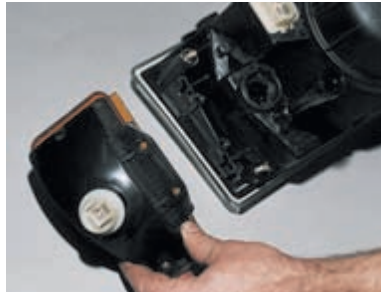
...и отсоединяем указатель поворота от фары. Для замены рассеивателя указателя поворота...
