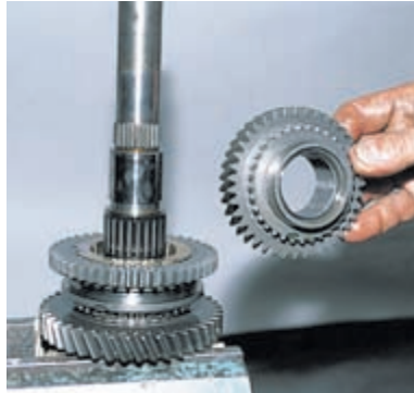
Снимаем шестерню II передачи...
