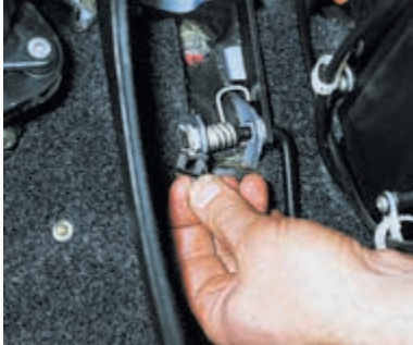
...снимаем стопорную скобу.
