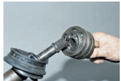
Снимаем шарнир. Шарнир на валу крепится стопорным кольцом, расположенным в проточке на конце вала.
