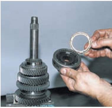
Снимаем ступицу синхронизатора III и IV передач в сборе с муфтой и блокирующие кольца синхронизатора.
