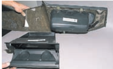
...и отсоединяем корпус нижнего вещевого ящика вместе с крышкой от панели приборов.
