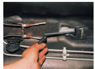
На регулировочную тягу не забудьте надеть пыльник.
