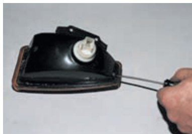
...отворачиваем шлицевой отверткой два винта...
