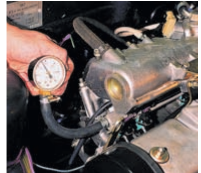
Пускаем двигатель и при работе на холостом ходу проверяем давление топлива, которое должно быть 2,8–3,2 бар (280–320 кПа).
