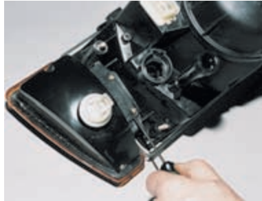
Шлицевой отверткой отворачиваем два винта...
