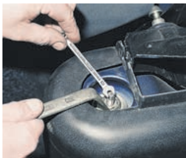
Накидным ключом «на 17» отворачиваем гайку, удерживая шток амортизатора ключом «на 6».
