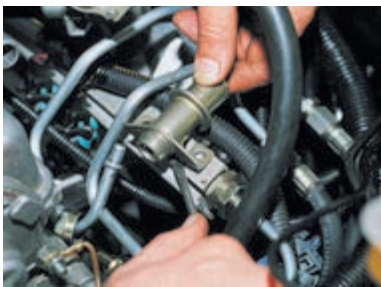
Поддеваем регулятор отверткой...
