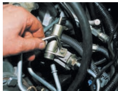
Отводим трубку от регулятора.
