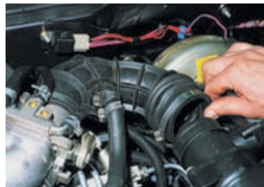
...и снимаем воздушный шланг с корпуса датчика массового расхода воздуха.
