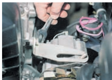
Ключом «на 13» отворачиваем болт крепления натяжной планки...
