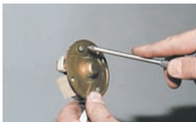
Крестообразной отверткой отворачиваем два винта крепления щеткодержателя к задней крышке.
