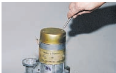
Крестообразной отверткой отворачиваем два винта защитного кожуха.
