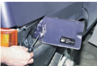
Крестообразной отверткой отворачиваем два винта...
