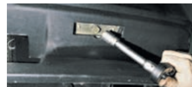
Головкой «на 17» отворачиваем снизу два болта переднего крепления бампера. Вынимаем болты.
