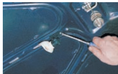
Крестообразной отверткой отворачиваем саморез крепления подкапотной лампы...
