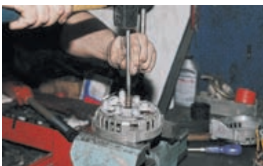
Выколоткой, упирающейся строго в торец вала ротора (чтобы не повредить пластмассовую втулку, расположенную под контактными кольцами),
