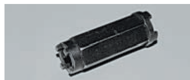
Ключ для гаек резервуаров передних и задних амортизаторов
