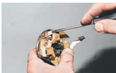
Поддеваем отверткой пластиковую скобу...
