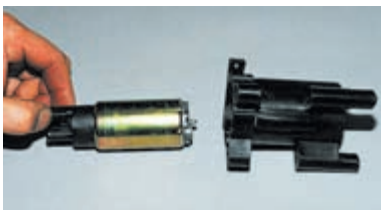
Отверткой освобождаем фиксирующую шайбу и снимаем фильтр топливозаборника.
