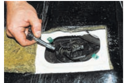
Головкой «на 7» отворачиваем шесть гаек крепления бензоприемника к баку.
