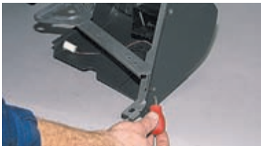
...и два самореза левого крепления поперечины.
