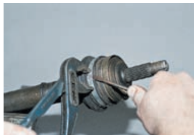
Раздвижными пассатижами сжимаем за выступы большой хомут и, поддевая отверткой, разъединяем его.
