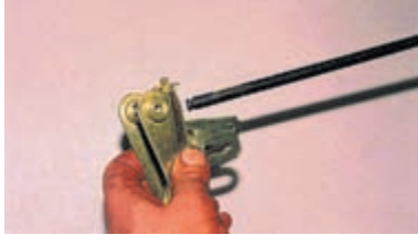
...и разъединяем рычаги привода регулятора давления.
