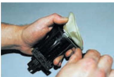
Отверткой освобождаем фиксирующую шайбу и снимаем фильтр топливозаборника.
