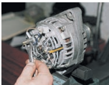
Ключом «на 10» отворачиваем гайку,
