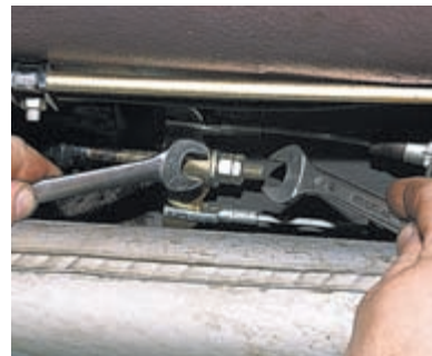
Удерживая ключом «на 13» регулировочную гайку тяги, ключом той же размерности ослабляем контргайку.
