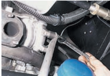
Ключом «на 13» отворачиваем гайку верхнего крепления правого кронштейна коллектора...
