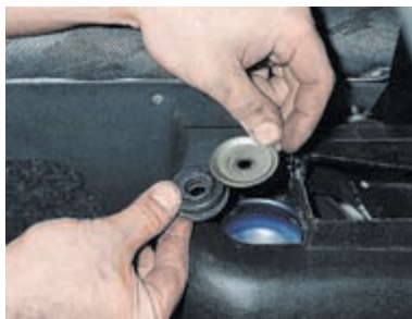
Снимаем гайку, пружинную и опорную шайбы, верхнюю подушку.
