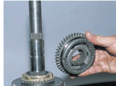
Снимаем скользящую муфту синхронизатора I-II передач со ступицей и блокирующим кольцом синхронизатора II передачи.
