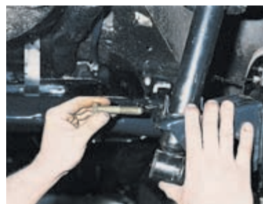
Вынимаем болт. При затруднении выбиваем болт выколоткой из мягкого металла.
