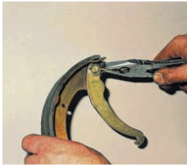
Расшплинтовываем ось рычага ручного привода колодок.
