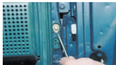
Крестообразной отверткой отворачиваем саморез...
