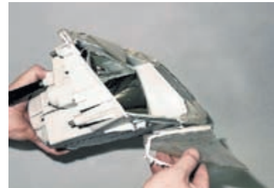
Удаляем осколки стекла. Очищаем внутреннюю поверхность фары, стараясь не повредить отражатель.
