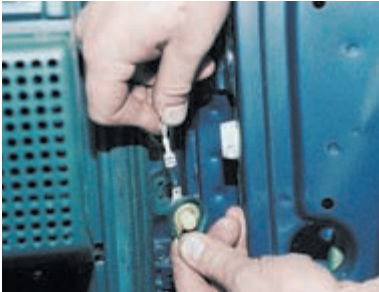
Отсоединив провод, снимаем выключатель освещения салона.
