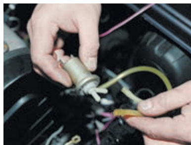
Снимаем с клапана трубки. Трубки стеклоомывателя удобно надевать на штуцеры, разогрев их пламенем зажигалки.
