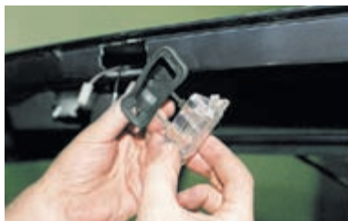
Снимаем защитный резиновый колпак.
