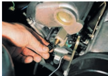
Отворачиваем пробку штуцера на топливной рампе.
