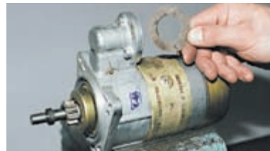
Соединение тягового реле и передней крышки уплотнено прокладкой.
