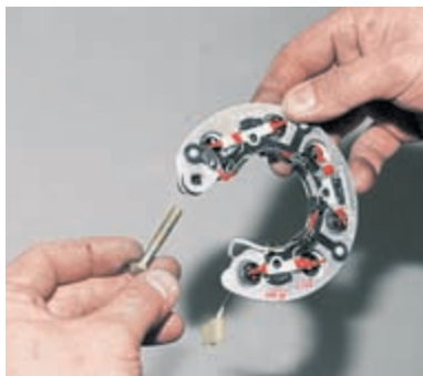
Вынимаем из выпрямительного блока контактный болт.
