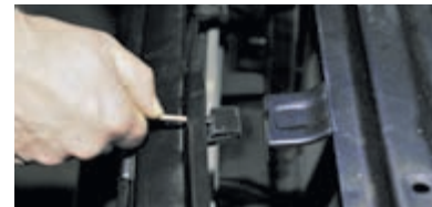
Шлицевой отверткой отжимаем вниз язычок центрального фиксатора и выводим фиксатор из кронштейна.
