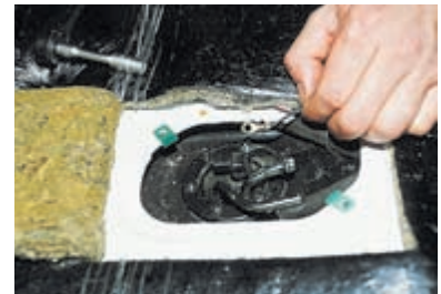
Снимаем со шпильки «массовый» провод датчика уровня.
