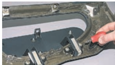
Крестообразной отверткой отворачиваем четыре самореза крепления петель крышки верхнего вещевого ящика...
