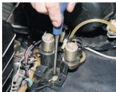
Крестообразной отверткой отворачиваем два самореза крепления кронштейна клапанов, под один из них заведен «массовый» провод.
