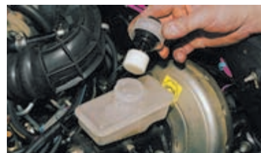
Отворачиваем крышку бачка. Резиновой грушей или шприцем откачиваем из него тормозную жидкость.
