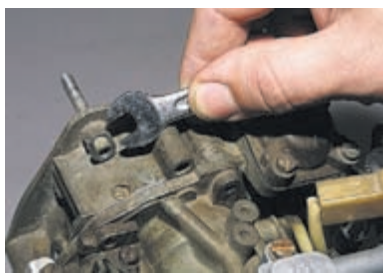
...завернув шпильку в крышку немного глубже, наворачиваем на нее гайку.
