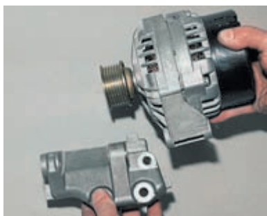
Разъединяем генератор и кронштейн.
