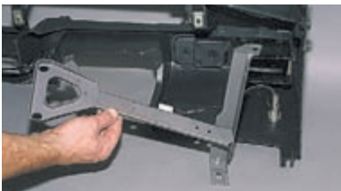
Левую поперечину можно снять только вместе с ее кронштейном.
