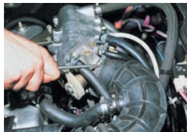
Ослабляем хомут крепления воздушного шланга к дроссельному патрубку...
