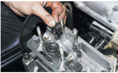
Вынимаем тарелку пружин...
