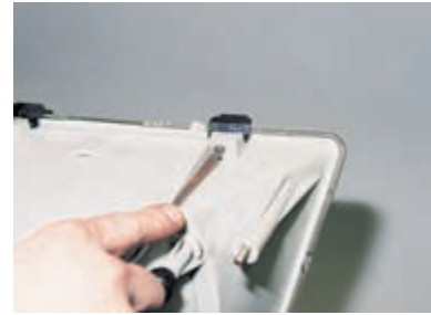
...шлицевой отверткой отворачиваем два винта крепления ограничителя хода фароочистителя.
