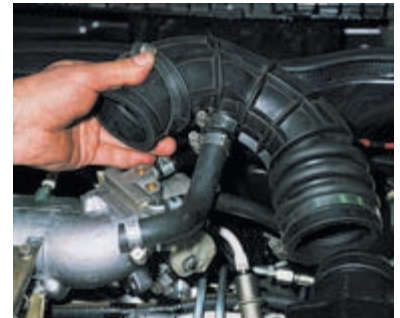
Снимаем воздушный шланг в сборе со шлангом вентиляции картера.
