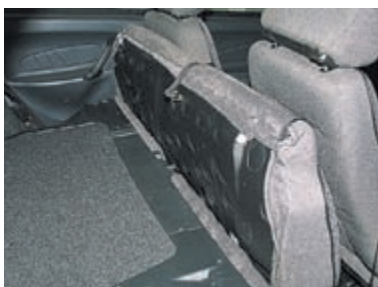
...и укладываем спинку сиденья. Разложенное заднее сиденье вместе с багажным отсеком образуют площадку для длинномерного груза.
