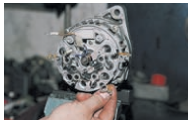
Отводим концы обмоток статора...
