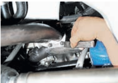
Отгибаем стопорные пластины гаек.
