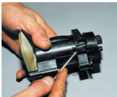
Освобождаем три фиксатора крышки.
