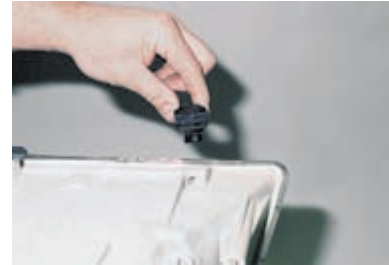
Снимаем ограничитель хода щетки фароочистителя.
