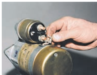
Снимаем наконечник провода.
