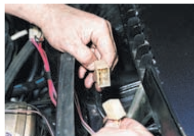
Отсоединяем разъем моторедуктора стеклоочистителя.
