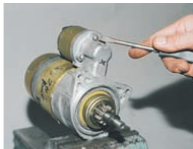
Отворачиваем три винта крепления тягового реле.
