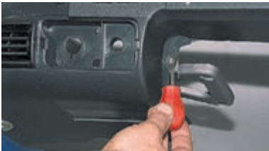
...крестообразной отверткой отворачиваем саморез правого крепления (в нише рулевой колонки)...
