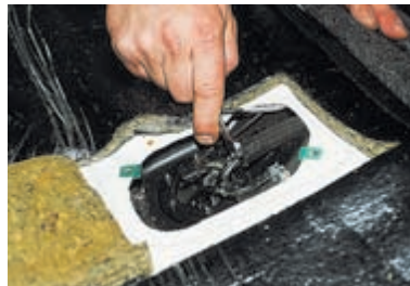
Шланги на трубках сидят очень плотно. Поэтому для их снятия надеваем поочередно зев ключа «на 10» на трубки...
