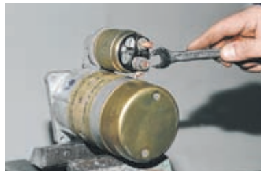
Ключом «на 13» отворачиваем гайку нижнего контактного болта.
