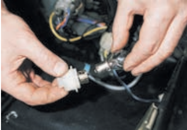
Нажав и повернув против часовой стрелки лампу, снимаем ее. Для снятия блок-фары...
