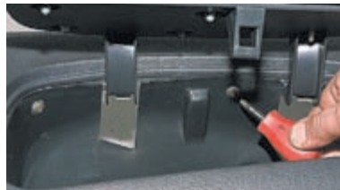
...крестообразной отверткой отворачиваем два самореза (верхних) внутри верхнего вещевого ящика...
