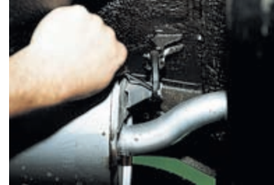
Отверткой отсоединяем от крюка переднюю,
