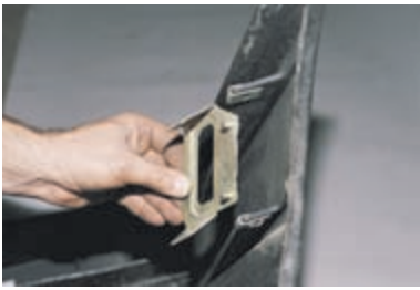
...и снимаем кронштейн.
