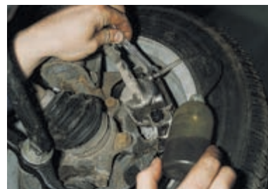
Прокачиваем колесные цилиндры передних тормозов.
