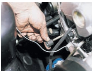
Снимаем со шпильки впускного коллектора втулку.
