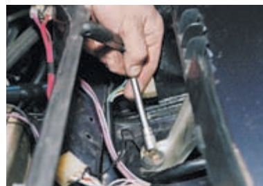
Головкой «на 10» отворачиваем болт крепления стеклоочистителя к кузову.
