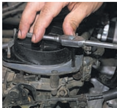
...метчиком М6 нарезаем резьбу в отверстии.
