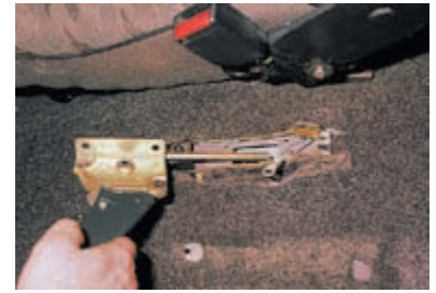
Сдвинув рычаг вперед, снимаем его.
