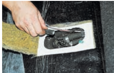
Отсоединяем разъем датчика уровня топлива.
