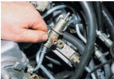
Поддеваем регулятор отверткой...
