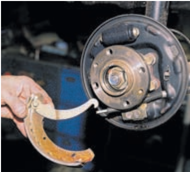
Отсоединив направляющую пружину от задней тормозной колодки, выводим рычаг ручного привода колодок из наконечника троса.
