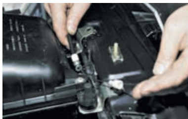
Выводим трос привода замка из крепления.
