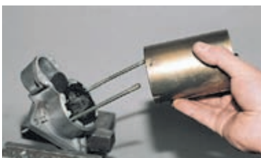
Снимаем статор вместе с якорем со шпилек крышки.
