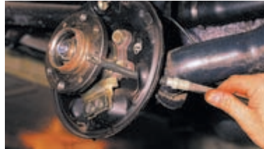
Вынимаем трос из щита тормозного механизма.
