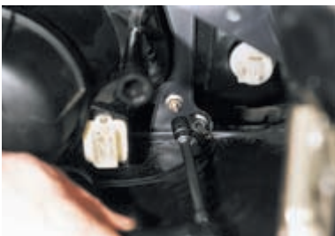
Головкой «на 10» отворачиваем четыре гайки крепления фары...
