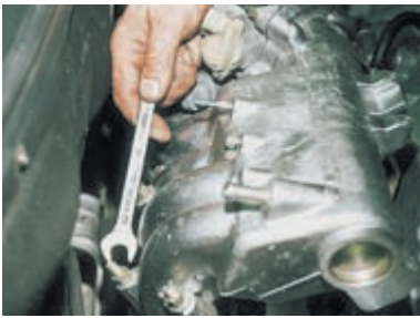
...и пять гаек крепления к впускному коллектору.
