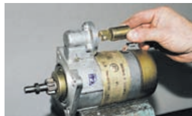
Вынимаем якорь тягового реле.
