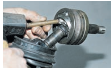
Через выколотку из мягкого металла сбиваем шарнир, нанося удары по торцу обоймы.
