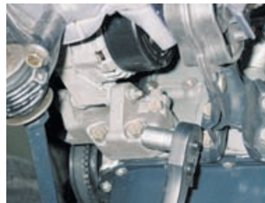
Головкой «на 17» отворачиваем три болта крепления нижнего кронштейна генератора к блоку цилиндров.
