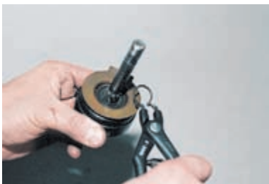
Разжимаем стопорное кольцо...
