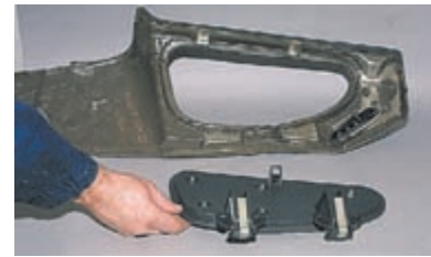
...и отсоединяем крышку вместе с петлями от накладки панели приборов.
