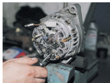
Крестообразной отверткой отворачиваем винт крепления выпрямительного блока и три винта крепления концов обмоток статора.
