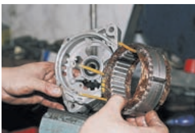
Статор от передней крышки также отделяем отверткой.
