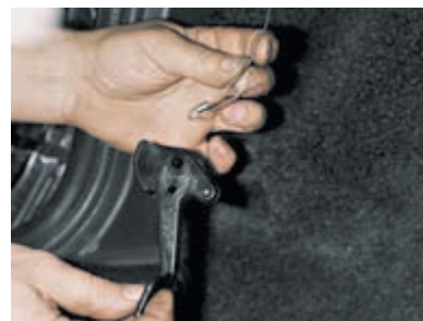
...снимаем петлю троса с рукоятки,
