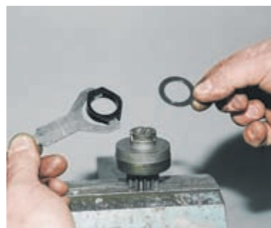
...и снимаем рычаг с кольцом отводки.
