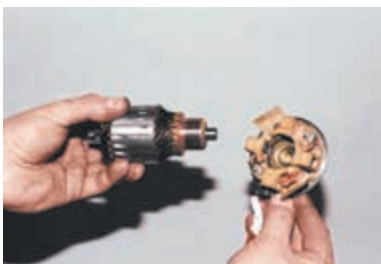
...якорь вставляем в заднюю крышку при снятых пружинах всех четырех щеток, когда щетки утоплены в направляющие.
