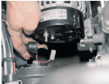
Ключом «на 10» отворачиваем гайку крепления наконечников проводов к выводу «В+»...
