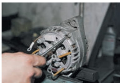
Крестообразной отверткой отворачиваем четыре винта, стягивающих крышки.
