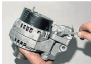
Ключом «на 13» отворачиваем гайку крепления генератора к кронштейну.
