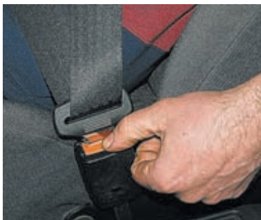
Чтобы отстегнуть ремень, нажимаем кнопку замка.
