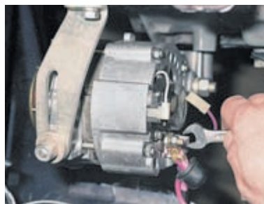
Ключом «на 10» отворачиваем гайку крепления проводов к выводу «30» генератора...
