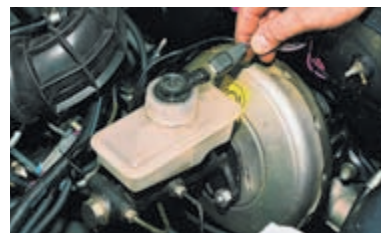
Отсоединяем разъем датчика аварийного (минимального) уровня тормозной жидкости.
