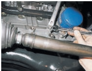
...и отворачиваем нижний болт крепления кронштейна к блоку цилиндров.
