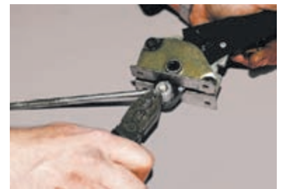
Расшплинтовываем ось регулировочной тяги.
