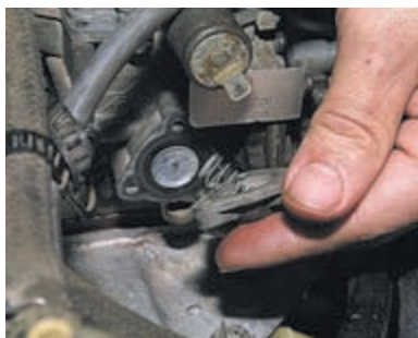
Снимаем крышку с пружинной.
