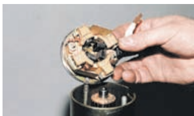
Снимаем заднюю крышку с щеткодержателем.
