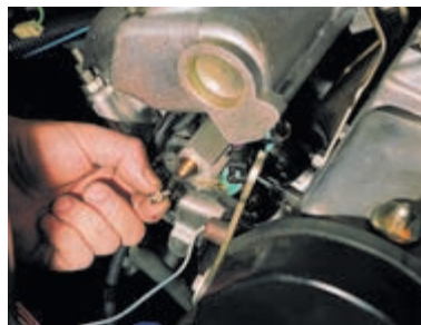
Отворачиваем пробку штуцера на топливной рампе.
