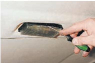
Поддеваем отверткой рассеиватель и снимаем его.
