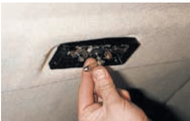
Вынимаем лампу. Для снятия плафона...
