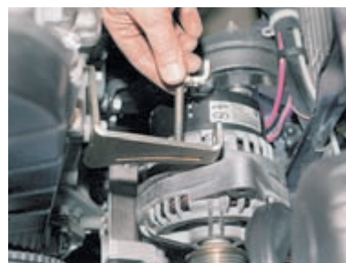
Вынимаем натяжную планку.
