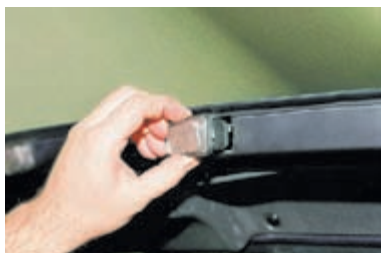
Поддев отверткой, снимаем фонарь.
