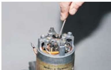
Поддеваем отверткой и снимаем стопорную шайбу и расположенную под ней шайбу.
