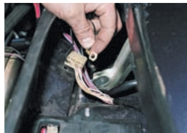
Под ним расположен «массовый» провод.
