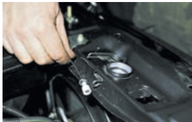
...отсоединяем трос привода замка от пружины.
