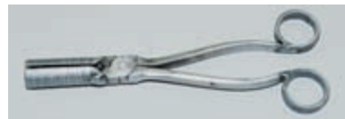
Щипцы для снятия маслоотражательных колпачков
