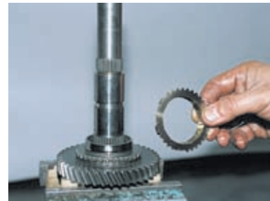
Снимаем блокирующее кольцо синхронизатора I передачи.
