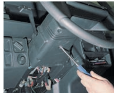
Отворачиваем саморез крепления нижнего кожуха к подрулевому переключателю...
