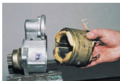
Поддев отверткой, отделяем корпус.
