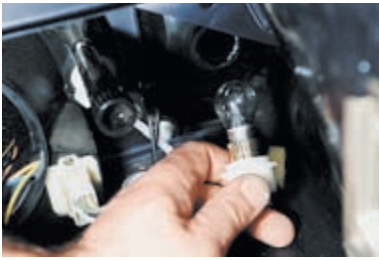
...и, повернув против часовой стрелки, вынимаем патрон из указателя поворота.
