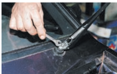
Ключом «на 10» отворачиваем гайку крепления поводка стеклоочистителя.
