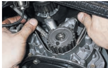
Поддеваем двумя отвертками зубчатый шкив коленчатого вала...
