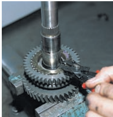
Щипцами разжимаем стопорное кольцо ступицы синхронизатора...
