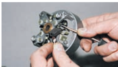
Для замены щеток отводим пружину и вынимаем щетку из направляющей.
