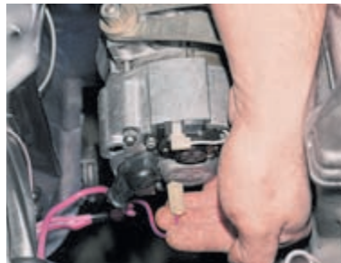
Отсоединяем провод вывода «В» генератора.
