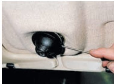
Поддеваем отверткой плафон.
