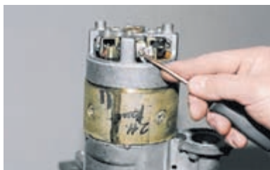
Отворачиваем два винта крепления выводов обмотки статора к щеткодержателям.
