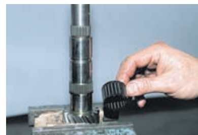
Снимаем игольчатый подшипник шестерни...
