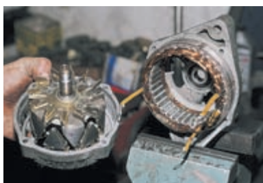
...разъединяем переднюю крышку со статором и заднюю крышку с ротором.
