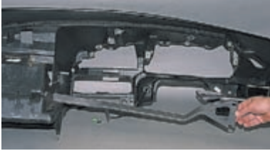
...выводим правую поперечину из панели приборов...
