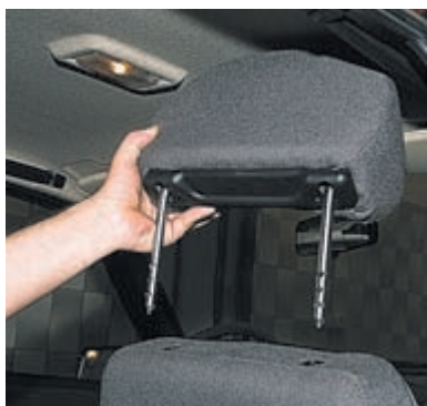
...и снимаем подголовник. Чтобы разложить заднее сиденье...
