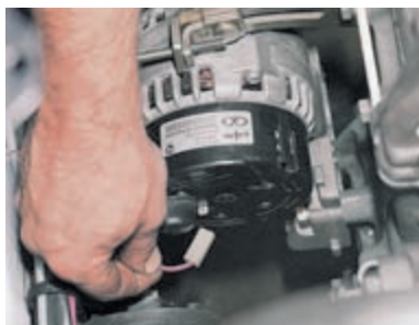
Отсоединяем колодку провода от вывода «D» генератора.
