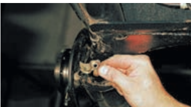
Снимаем скобу крепления троса.
