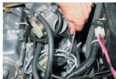
Крестообразной отверткой отворачиваем винт прижимной планки...
