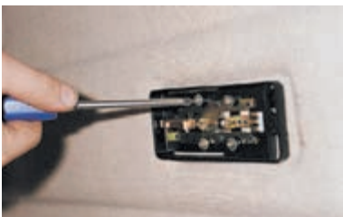
...крестообразной отверткой отворачиваем четыре самореза.
