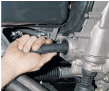
Для этого можно применить заглушку из куска резинового шланга подходящего диаметра. Левый привод демонтируем аналогично правому,
