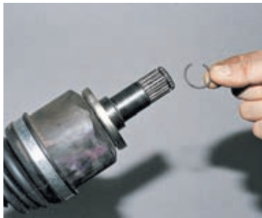
...и снимаем его со шлицевого конца корпуса внутреннего шарнира.
