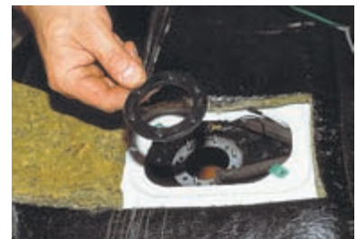
Снимаем прокладку бензоприемника.
