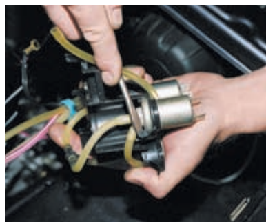
Приподнимаем кронштейн и, отжав отверткой два фиксатора, снимаем клапан.
