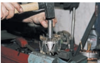
Новый подшипник запрессовываем подходящим отрезком трубы, прикладывая усилие к внутреннему кольцу.
