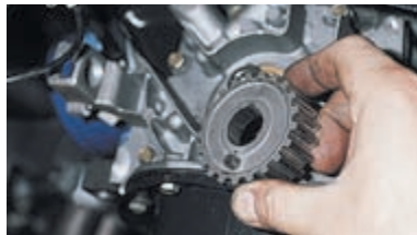
...и снимаем его с носка коленчатого вала.
