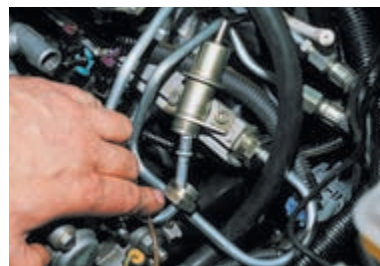
Отводим трубку от регулятора.
