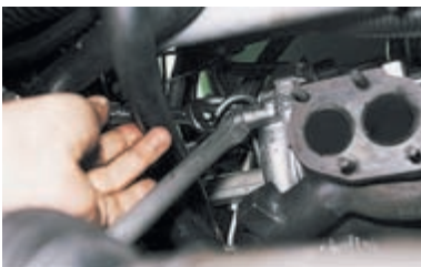
Ключом «на 17» отворачиваем гайку верхнего крепления левого кронштейна впускного коллектора.
