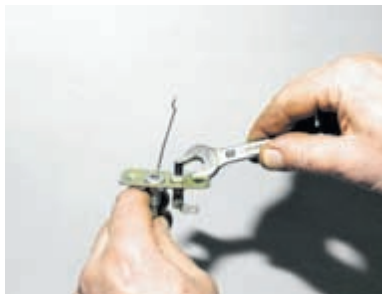
Ключом «на 11» отворачиваем выключатель...
