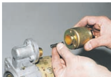
Снимаем тяговое реле и пружину.
