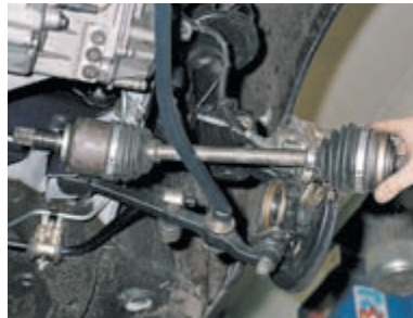
Выпрессовываем корпус внутреннего шарнира и снимаем левый привод.
