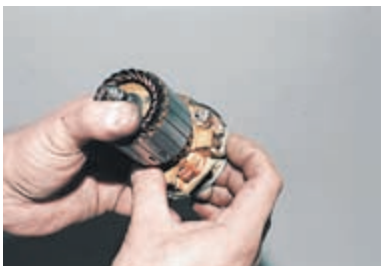
Ставим пружины и защелкиваем скобы.
