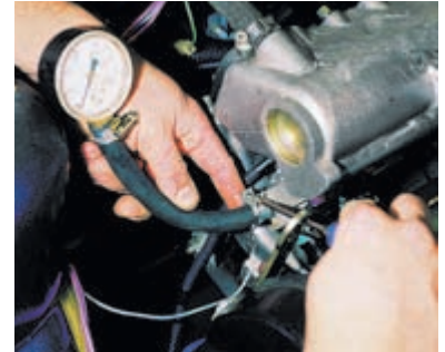
На штуцер рампы надеваем шланг манометра и закрепляем его хомутом.
