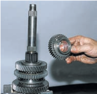
Снимаем ведомую шестерню III передачи...
