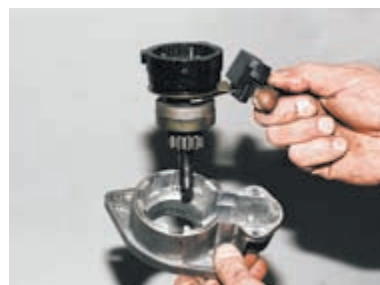
Снимаем вал привода с рычагом.
