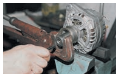
Через отверстие высокой головки «на 21» (удерживаемой трубным ключом) вставляем шестигранный ключ «на 8» и отворачиваем гайку.
