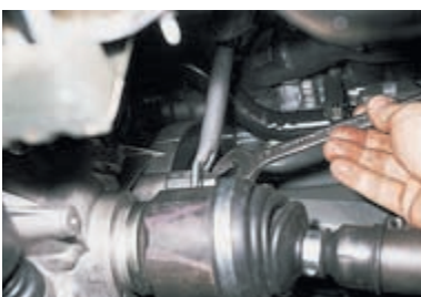
Ключом «на 19» отворачиваем гайку нижнего крепления кронштейна к картеру коробки передач.
