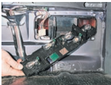
...снимаем плату заднего фонаря.
