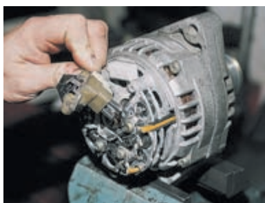
...и отводим регулятор напряжения с щеткодержателем.
