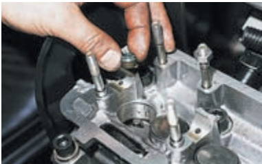
...снимаем маслоотражательный колпачок с направляющей втулки клапана.
