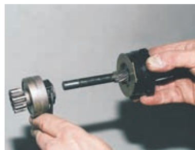
Сдвигаем по валу привод с рычагом.
