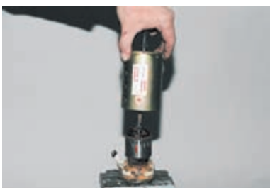
Придерживая длинной отверткой якорь от притягивания его постоянными магнитами статора,
