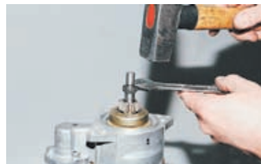
Установив стартер вертикально, постукивая молотком по рожковому ключу «на 14», спрессовываем ограничительное кольцо.
