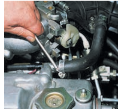
...и хомут крепления шланга вентиляции картерных газов к патрубку крышки головки цилиндров.
