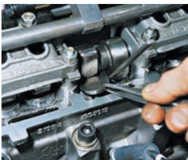
Рис. 2. Фиксирование толкателей клапанов при замене регулировочной шайбы: 1 – фиксатор; 2 – регулировочная шайба
