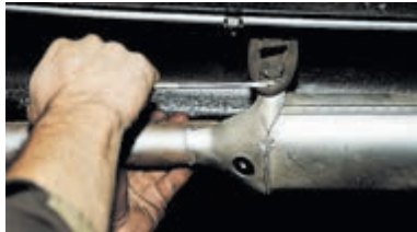
Отсоединяем две подушки подвески дополнительного глушителя...
