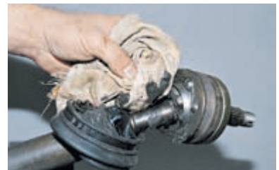
Протираем и очищаем от старой смазки торцевую часть шарнира.
