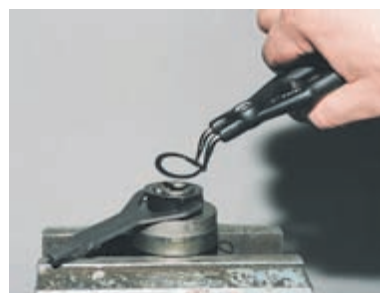
Щипцами разжимаем стопорное кольцо...
