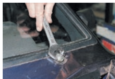
Ключом «на 24» отворачиваем гайку.
