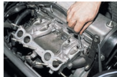
Ключом «на 13» отворачиваем две гайки крепления рыма.
