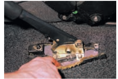
Головкой «на 10» отворачиваем четыре болта крепления кронштейна рычага к полу.
