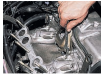
Ключом «на 13» отворачиваем три гайки крепления кронштейна ресивера...
