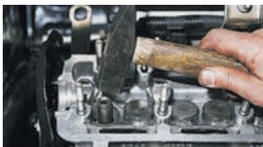
Смазав новый колпачок моторным маслом, напрессовываем его оправкой на направляющую втулку.
