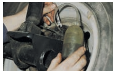
Прокачиваем колесные цилиндры задних тормозов.
