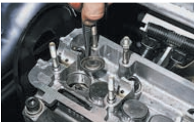
Вынимаем опорную шайбу пружин.
