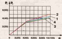
Рис. 6.19. Диаграмма проверки работоспособности регулятора давления: P_1 – давление на входе в камеры А и D (см. рис. 6.18) регулятора давления; P_2 – давление на выходе из камеры В; P_3 – давление на выходе из камеры С; 1 – номинальная величина давления P_2 ; 2 – верхняя граница давления P_2 ; 3 – нижняя граница давления P_2 ; 4 – давление P_3
