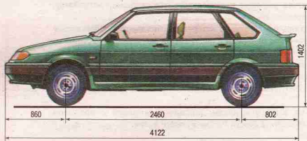
Рис. 1.1б. Габаритные размеры (справочные) автомобиля ВАЗ-2114
