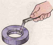
Рис. 2.40. Проверка зазора в замке колец
