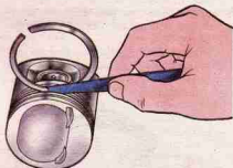
Рис. 2.39. Проверка зазора между поршневыми кольцами и канавками
