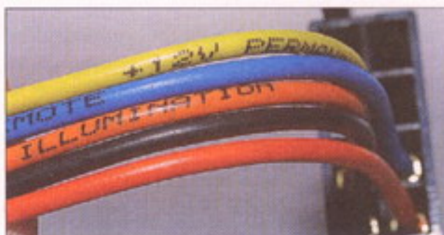
На проводах колодки питания указано назначение каждого провода.
