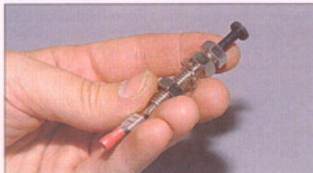
Датчик открытия капота или багажника (двери задка), представляющий собой кнопочный выключатель концевой типа
