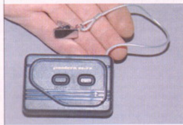
Брелок пейджера имеет кнопки включения и выключения. Провод с прищепкой служит не только для того, чтобы удерживать брелок на связке ключей, но и является антенной
