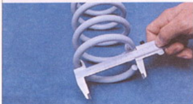
Фото 5. При таком измерении внутреннего диаметра ошибки будут значительны
