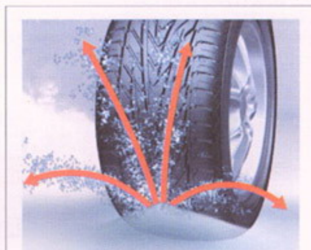
Схема отвода воды протектором скоростной шины
