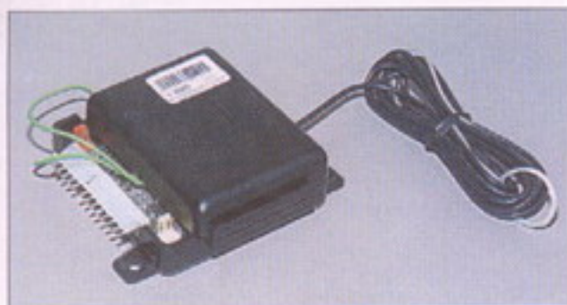
Центральный блок сигнализации с антенной
