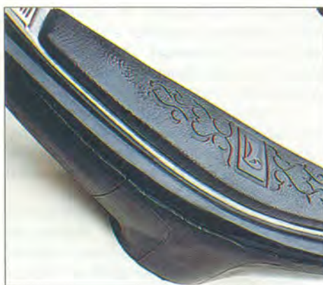
Фото 1. Руль на ВАЗ–2106 (служит с 1986 г.). Видны трещины на его облицовке.
