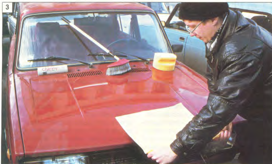
Инструмент мойщика: 1 – щетка со специальной щетиной – мягкой, распушенной на концах и жесткой у основания; 2 – это не сыр, а губка с крупными глубокими порами; 3 – искусственная замша в работе.
