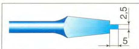
Рис. 3. Отвертка, приспособленная для снятия шайбы.
