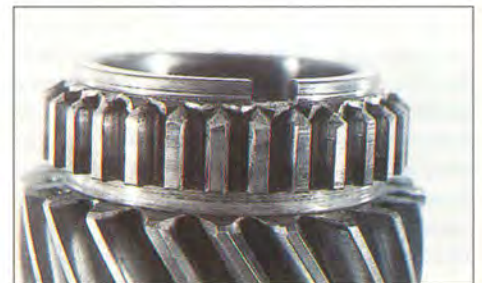
Фото 6. Состояние шлицев ведомой шестерни.
