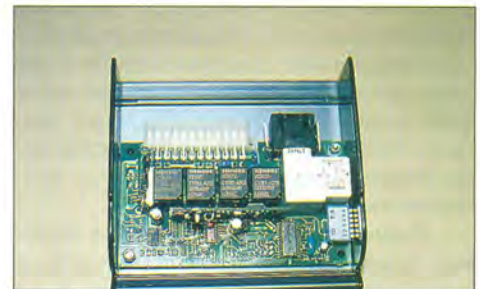
Так выглядит начинка сигнализации "Лазерлайн-996" с встроенным иммобилайзером.
