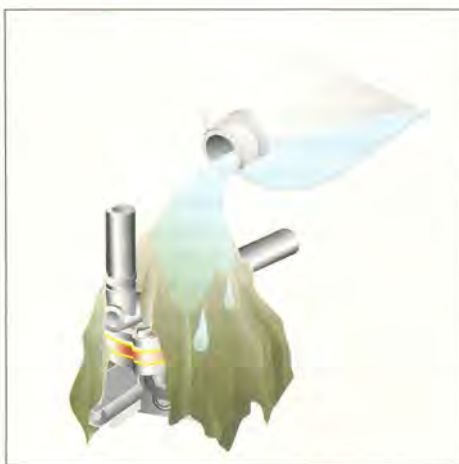
Рис. 1. Перегревшийся бензонасос охлаждают мокрой тряпкой.
