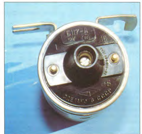
Катушки АТЭ-2 (сверху вниз): сухая, с замкнутым магнитопроводом 3122.3705; двухискровая 3009.3705; Б-117А.
