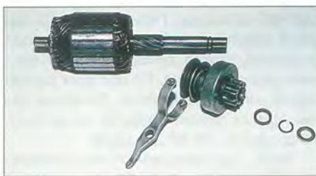
Фото 9. Якорь стартера предположительно при работе касался полюсов (видны следы). Привод с муфтой обгона и рычаг исправны.
