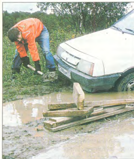
Пока картер коробки передач (или мост) опирается на грунт, машина с места не двинется. Лопатой убираем мешающую землю.
