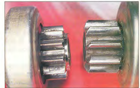
Рис. 6. Износ кромок зубьев шестерни стартера (слева). Справа – новая шестерня.
