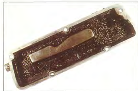
Рис. 3. Низкотемпературные отложения на клапанной крышке двигателя «Таврии». Для сравнения коробка маслоотражателя очищена.
