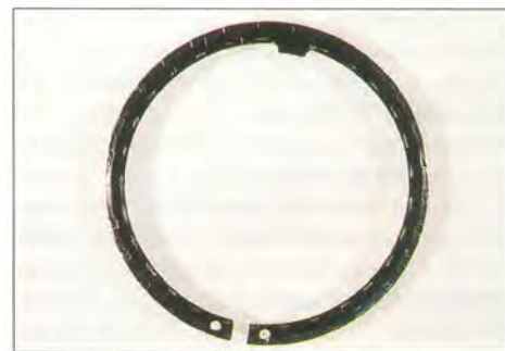
Фото 8. Изношенная стопорная шайба.
