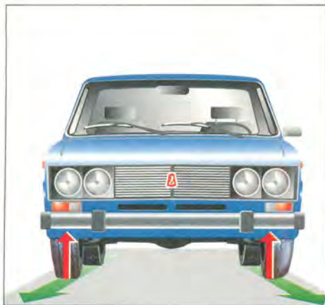
Рис. 1. Конусообразный износ одной шины (левой) в сочетании с новой шиной (правой) вызывает увод автомобиля.
