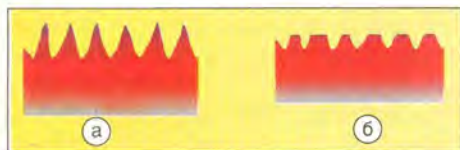
Рис. 1 Микронеровности на поверхности цилиндра двигателя: а – «Жигулей», обработанного классическим хонингованием; б – «Самары», обработанного по современной технологии – плоско-вершинным хонингованием
