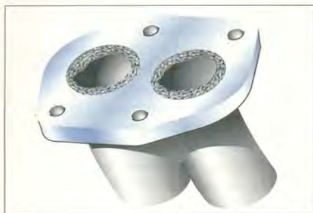
Рис. 2. Грубый сварной шов уменьшает "живое сечение" выпускных труб.
