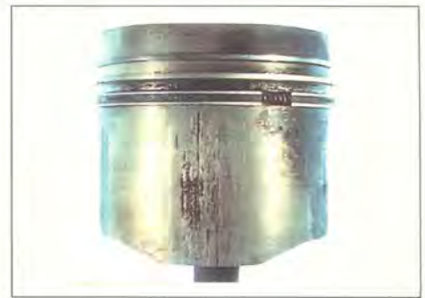
Фото 1. Глубокие царапины и задиры на юбке поршня ВАЗ-2108, на котором стояли «левые» кольца.
