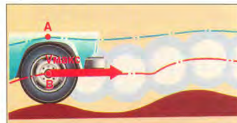
Рис. 3. Движение с высокой скоростью. Колесо отскакивает от волн покрытия; V_{макс} – скорость автомобиля.
