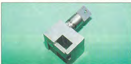
Фото 7. Устройство блокировки рулевого управления монтируют на маятниковом рычаге.
