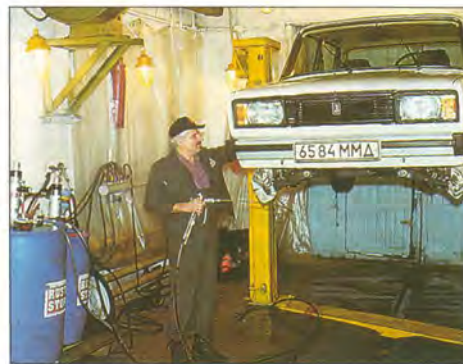
Обратите внимание: тормоза автомобиля защищены от загрязнения мастикой. Согласитесь, так делают далеко не на каждой станции.
