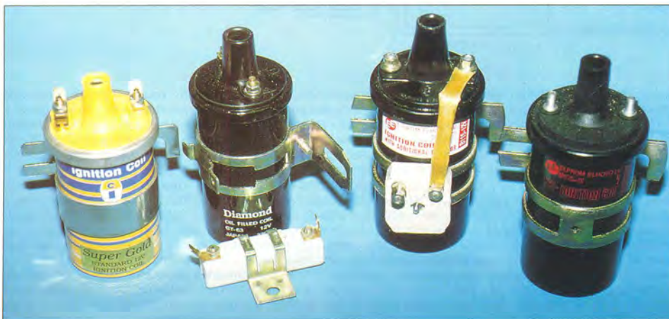
Катушки для контактных систем зажигания. Слева направо: английская, японская и две болгарские.
