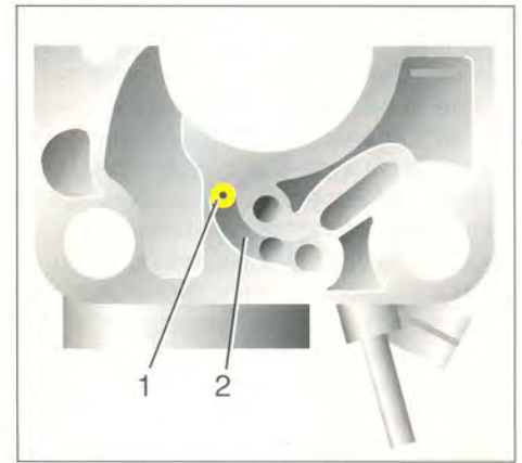
Рис. 2. Так выглядит байпасный канал "Озона": 1 – жиклер; 2 – канал.
