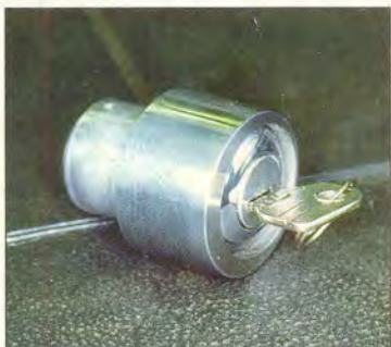
Фиксатор спинки, установленный на сиденье и отдельно. Как видим, съемная деталь противоугонного механизма может быть миниатюрной.
