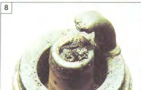
Рис. 3. Черный маслянистый нагар на изоляторе и электродах – значит, свеча «холодная» для данного двигателя. Рис. 4. Нормальная свеча.
