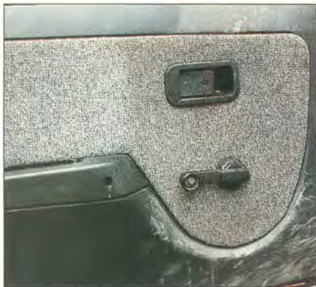
Водительская дверь "Таврии". Левая часть обработана препаратами фирмы "Turtle Wax" – для пластмассовых деталей и обивочных материалов. Правая половинка осталась необработанной.
