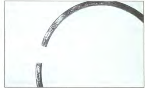
Фото 2. Эти кольца для «восьмерки» продавались как немецкие. Скол хрома, выход мотора из строя после пробега 1500 км.
