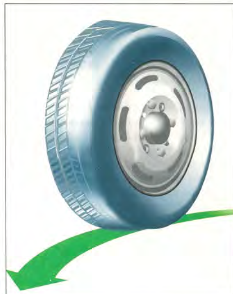
Рис. 3. Качение конусообразного тела (шины с односторонним износом).
