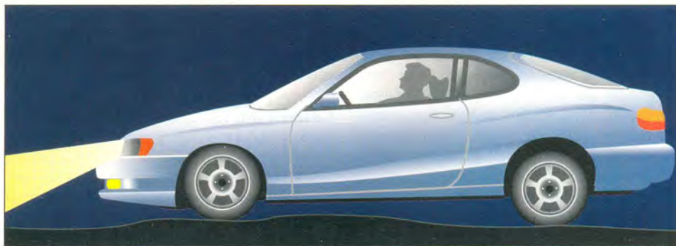
Рис. 3. «Клевки» из-за неисправности амортизаторов.
