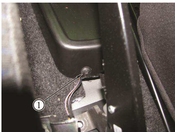
Рисунок 14-5 – Заднее крепление облицовки туннеля пола:
