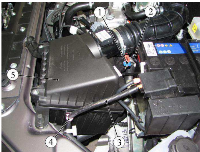
Рисунок 2-2 – Снятие воздушного фильтра со шлангом впускной трубы в сборе:
