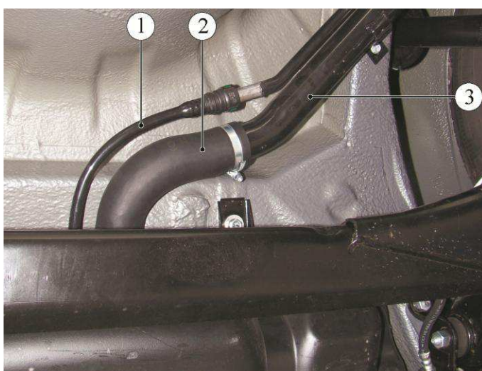
Рисунок 4-4 – Отсоединение шлангов от наливной горловины:
