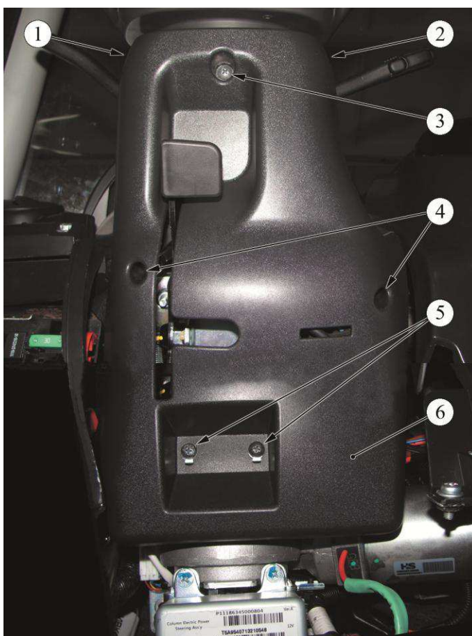
Рисунок 2-2 – Снятие облицовочных кожухов:
