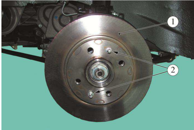
Рисунок 7-1 – Снятие диска переднего тормоза:
