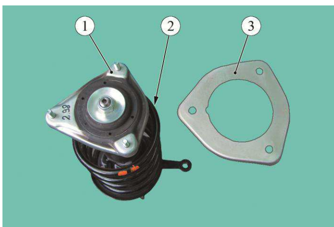
Рисунок 2-6 – Снятие нижней опоры с телескопической стойки передней подвески:
