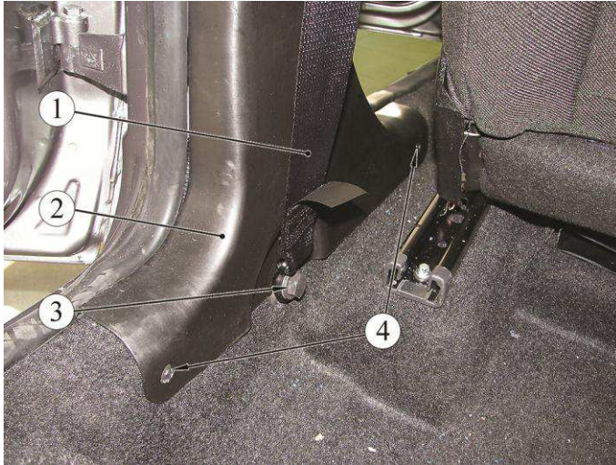
Рисунок 11-1 – Нижнее крепление переднего ремня безопасности:
