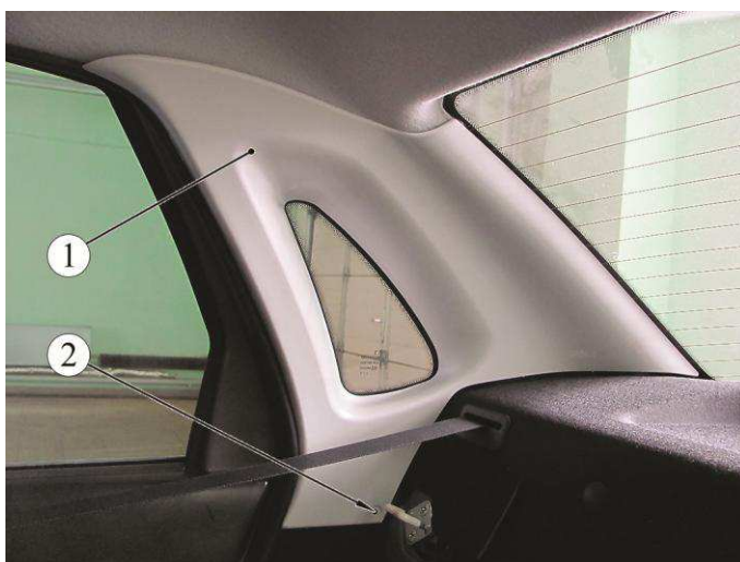
Рисунок 11-4 – Крепление обивки стойки задка.
