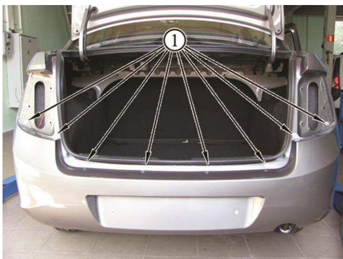
Рисунок 2-3 – Верхнее крепление бампера:
