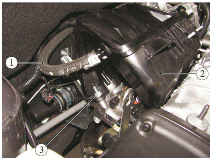
Рисунок 4-17 – Отсоединение шланга усилителя тормоза:
