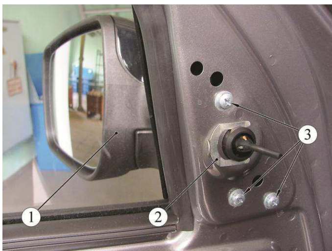
Рисунок 3-8 – Крепление зеркала заднего вида наружного:
