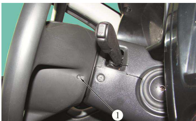
Рисунок 8 – Расположение правого технологического отверстия для снятия МНПБВ на рулевом колесе:
