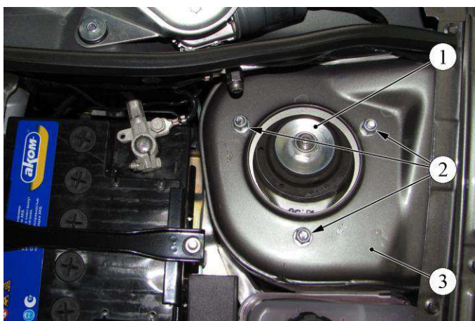
Рисунок 2-5 – Отсоединение стойки телескопической передней подвески от кузова автомобиля:
