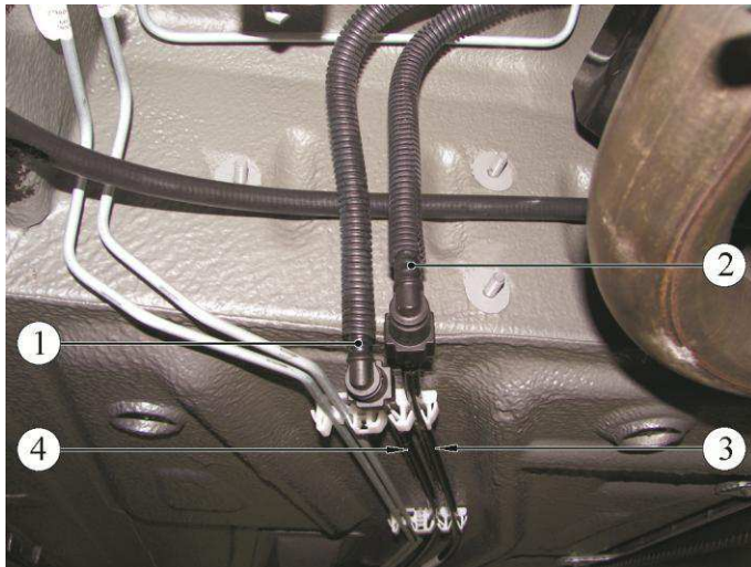
Рисунок 4-6 – Отсоединение топливных трубок:
