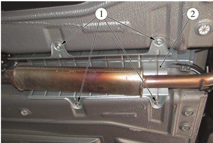
Рисунок 12-1 – Снятие экрана защиты пола кузова:
