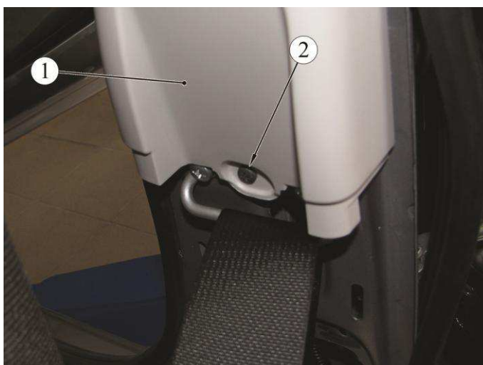
Рисунок 11-3 – Крепление обивки центральной стойки верхней.
