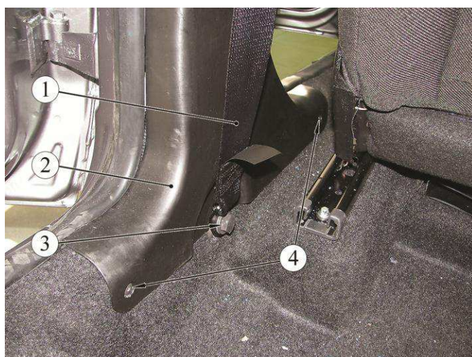
Рисунок 10-1 – Нижнее крепление переднего ремня безопасности:
