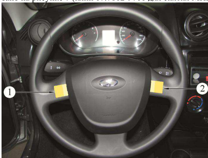
Рисунок 7 – Установка клиньев для снятия МНПБВ:
