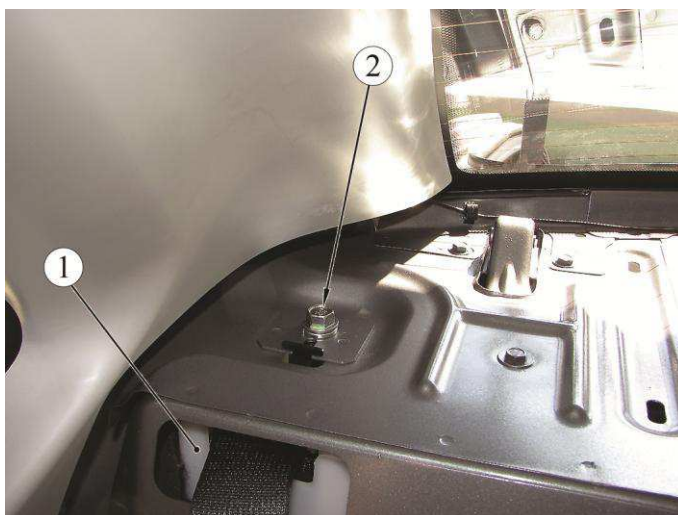
Рисунок 10-7 – Крепление инерционной катушки ремня безопасности:
