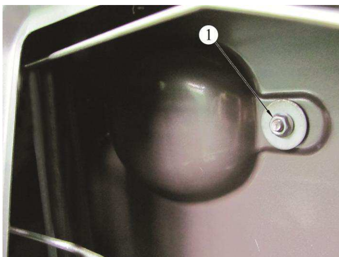
Рисунок 4-6 – Крепление ручки наружной задней двери:
