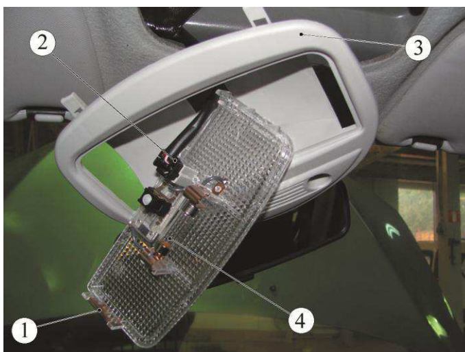
Рисунок 12-2 – Снятие плафона освещения салона:
