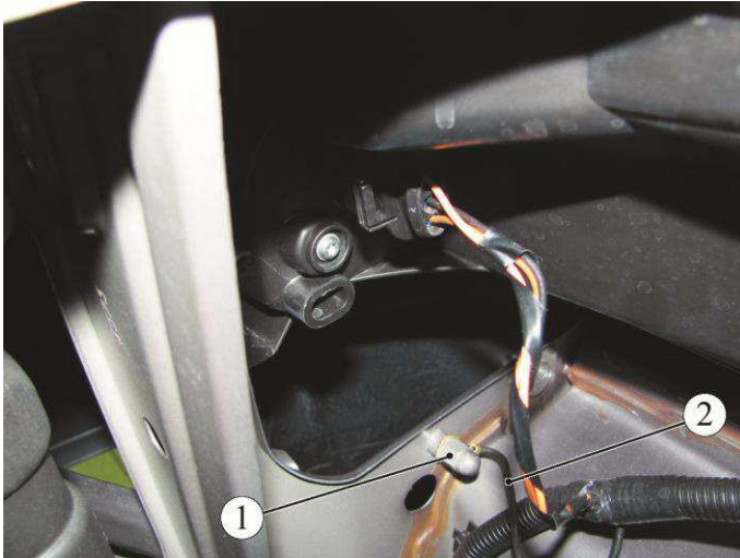
Рисунок 13-10 – Снятие провода "массы":
