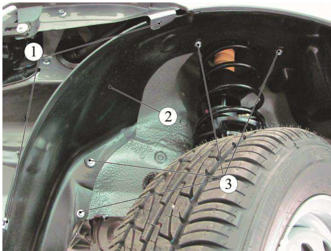
Рисунок 13-6 – Снятие щитка переднего крыла левого:
