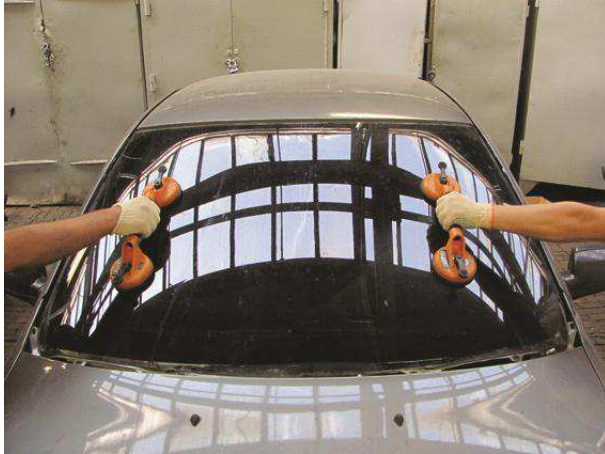
Рисунок 15-4 - Установка стекла с помощью держателей
