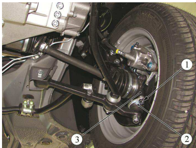
Рисунок 2-15 – Отсоединение шаровых пальцев от поворотных кулаков:
