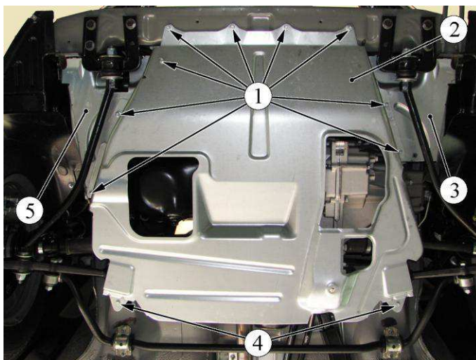
Рисунок 2-9 – Снятие брызговика двигателя:
