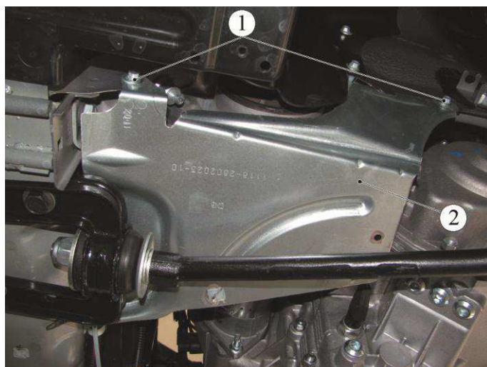
Рисунок 3-1 – Снятие брызговика двигателя левого:
