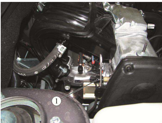
Рисунок 15-7 – Датчик контрольной лампы давления масла (дет. 11180-3829010-00):
