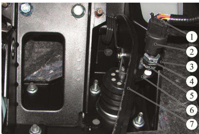
Рисунок 4-1 – Снятие выключателя сигнала торможения:
