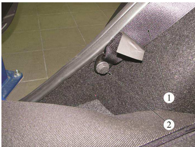
Рисунок 9-1 – Крепление заднего ремня безопасности:
