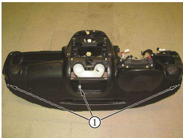
Рисунок 14-19– Крепление панели приборов к поперечине:
