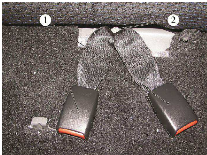
Рисунок 10-6 – Крепление замка ремня безопасности:
