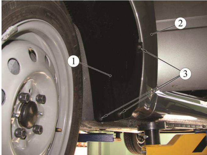
Рисунок 7-1 – Крепление щитка переднего крыла:
