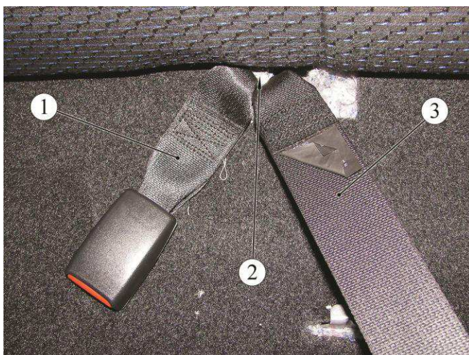
Рисунок 9-2 – Крепление ветви среднего ремня безопасности:
