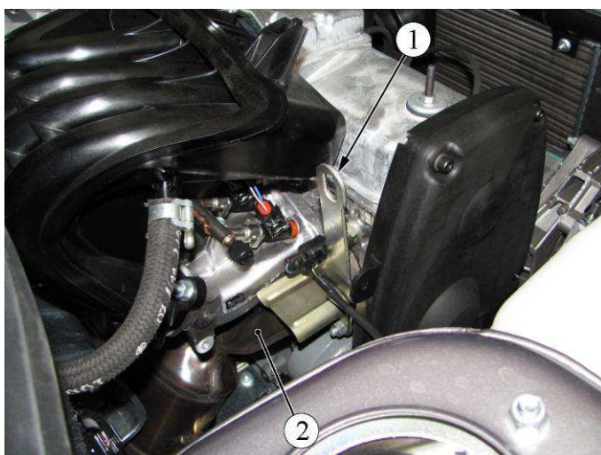
Рисунок 2-8 – Место подвески силового агрегата:
