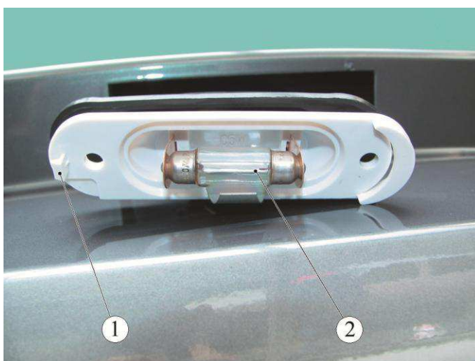
Рисунок 11-2 – Замена лампы фонаря освещения номерного знака:
