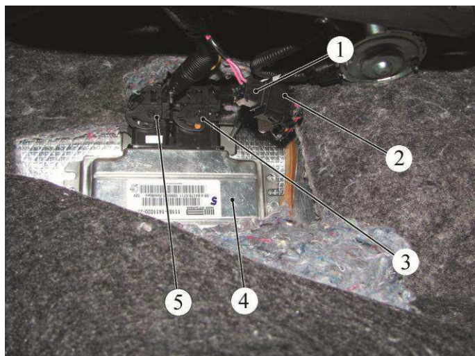
Рисунок 15-2 – Контроллер системы управления двигателем:
