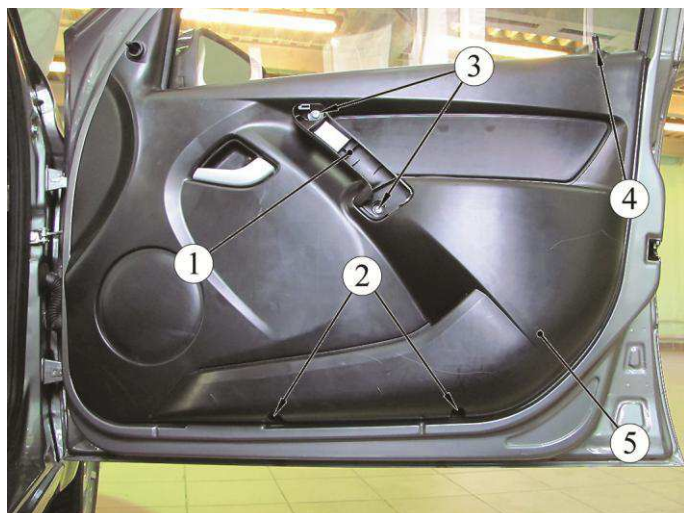
Рисунок 3-2 – Крепление обивки правой передней двери:
