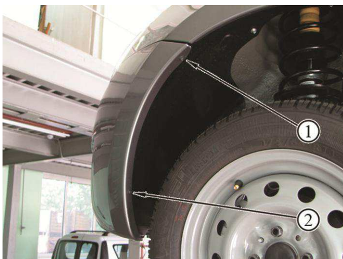
Рисунок 1-2 – Боковое крепление бампера:
