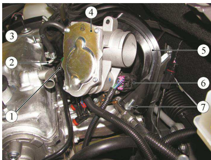
Рисунок 4-16 – Отсоединение колодки жгута от дроссельного патрубка:
