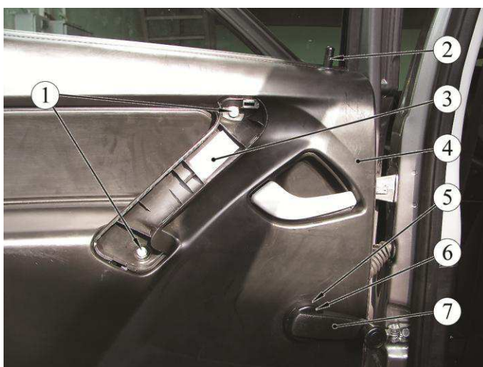
Рисунок 4-1 – Крепление обивки задней двери:
