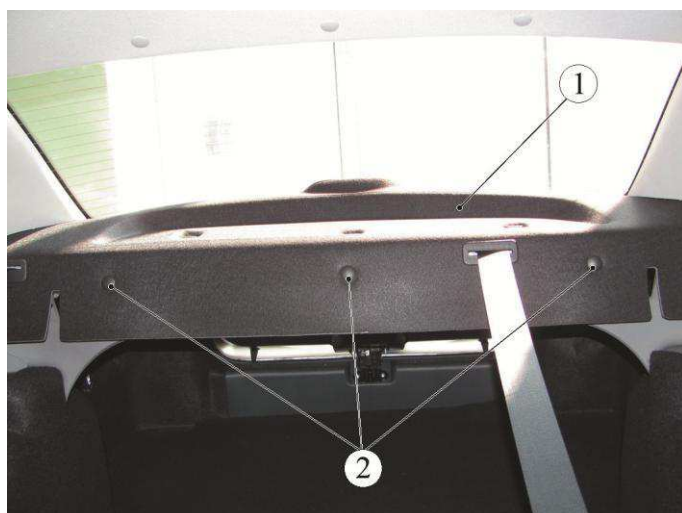
Рисунок 10-1 – Снятие полки багажника:
