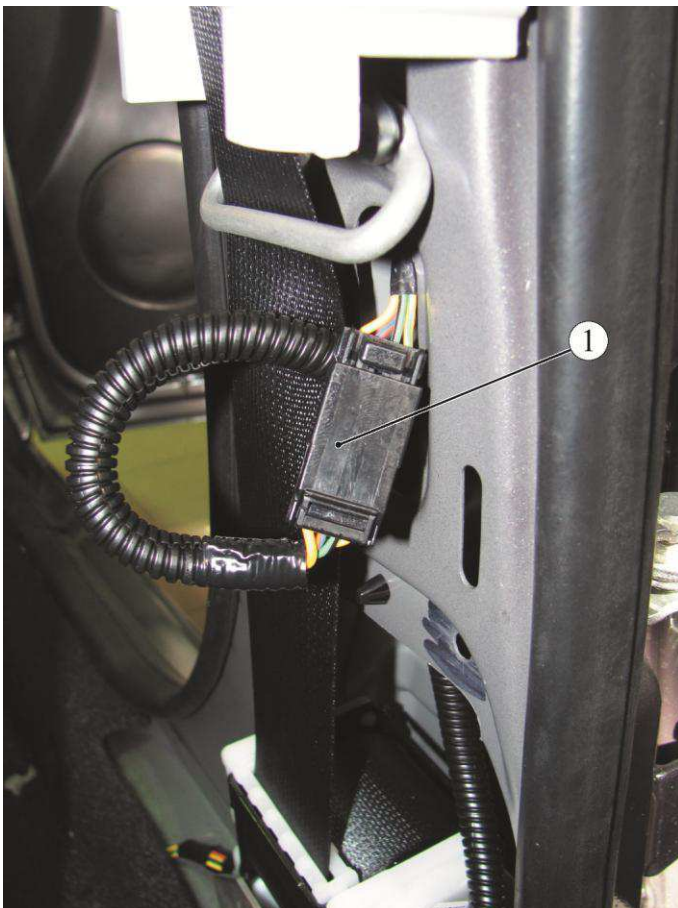
Рисунок 17-2 – Снятие колодок задней двери:
