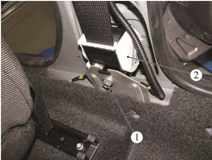
Рисунок 10-4 – Крепление инерционной катушки ремня безопасности:
