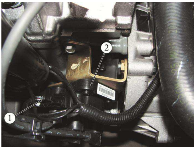
Рисунок 15-4 – Снятие колодки катушки зажигания:
