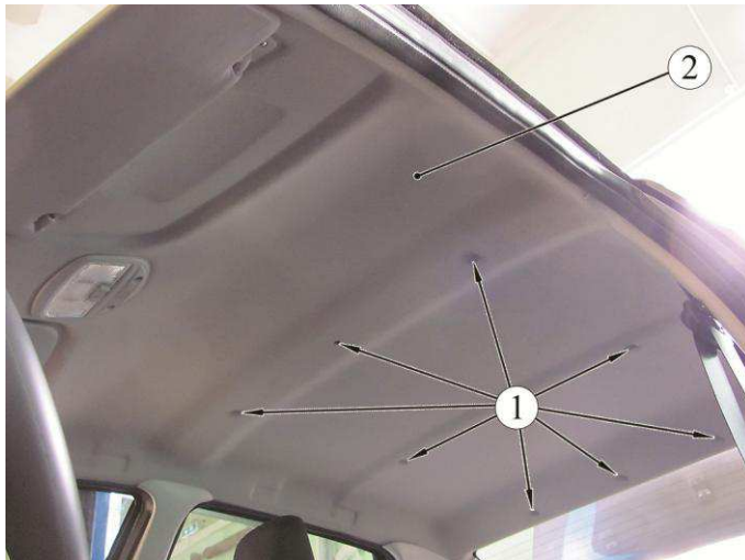
Рисунок 11-6 – Крепление обивки крыши:
