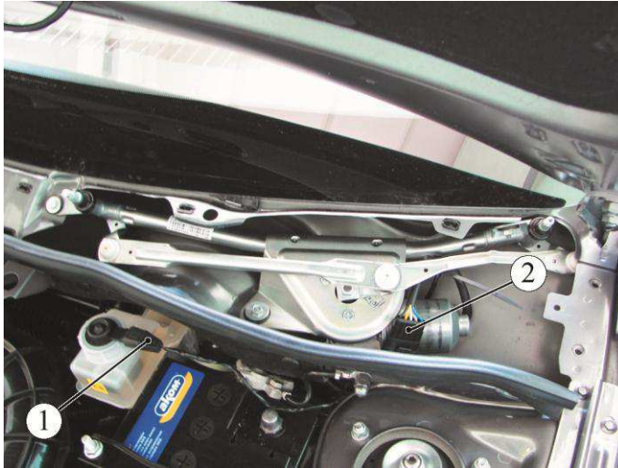
Рисунок 14-1 – Снятие жгута проводов коробки воздухопритока:
