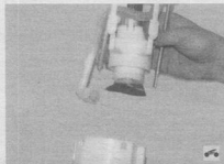
14. ...и снимите корпус модуля с направляющих кронштейна.
