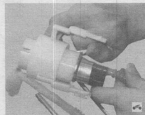
18. Для замены электронасоса отожмите пластмассовый фиксатор и извлеките электронасос из корпуса.
