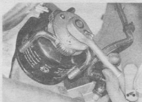
4. Специальным ключом строньте с места масляный фильтр и снимите его.
