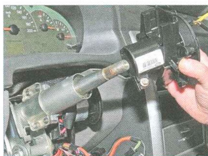
Головкой «на 8» ослабляем стяжной болт соединителя...
