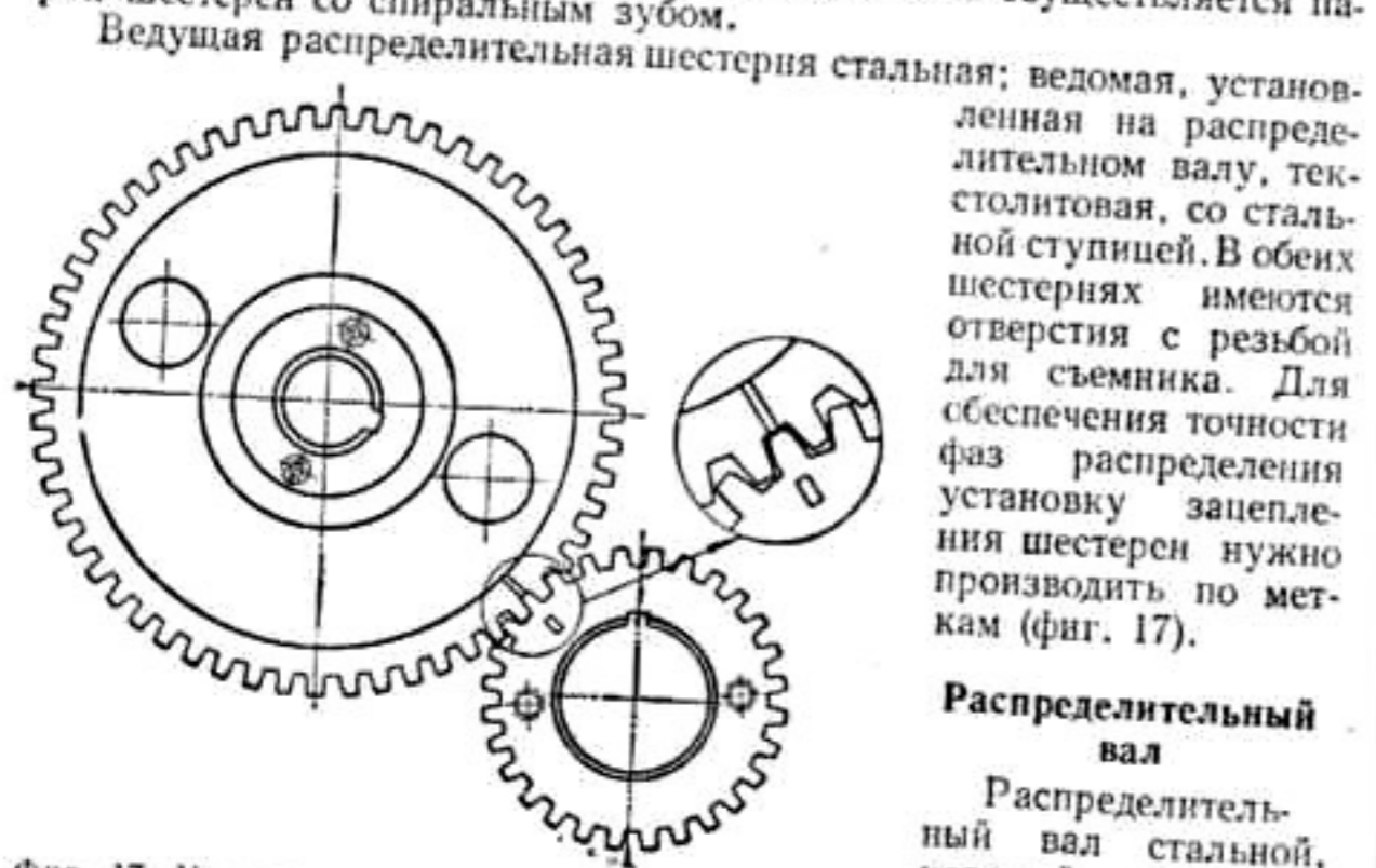
Фиг. 17. Установочные метки на распределительных шестернях.
