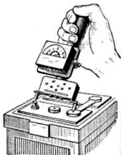
Фиг. 135. Проверка элементов аккумуляторной батареи нагрузочной вилкой.
