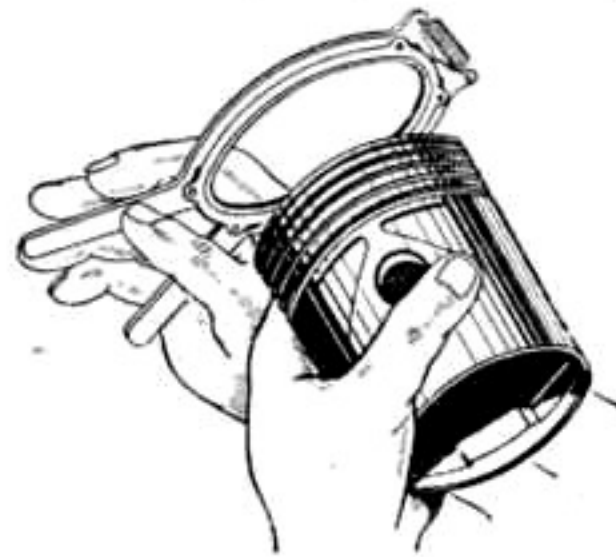
Фиг. 59. Съемник для поршневых колец.
