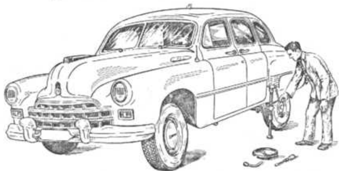
Фиг. 173 Подъем автомобиля домкратом.
