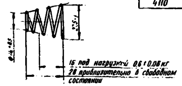
ПРУЖИНА АТМОСФЕРНОГО КЛАПАНА
