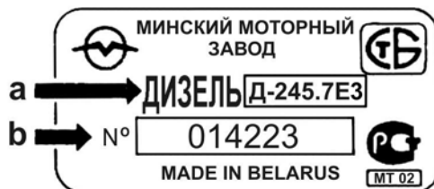
Рис. 1.2. Пример нанесение номера двигателя ММЗ Д-245.7 ЕЗ
