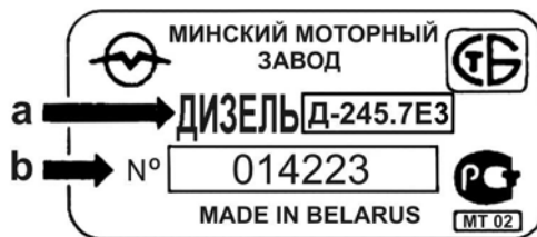
Рис. 1.2. Пример нанесение номера двигателя ММЗ
