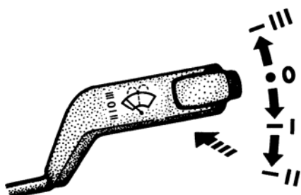
Рис. 5.7. Положение рычага переключателя стеклоочистителя и стеклоомывателя (без звукового сигнала)
