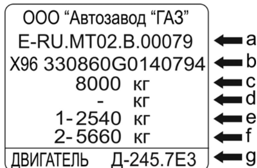
Рис. 1.3. Пример заводской таблички с паспортными данными автомобиля:
