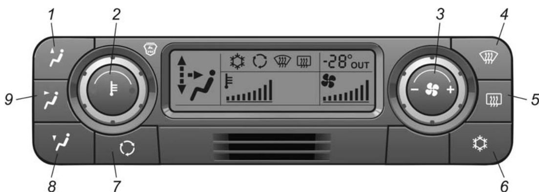
Рис. 8.1. Пульт управления отопительно-вентиляционной и климатической установкой
