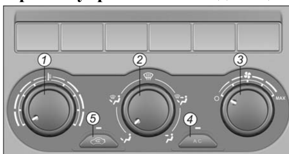
Рис. 8.5. Пульт управления отоплением, вентиляцией и кондиционированием воздуха
