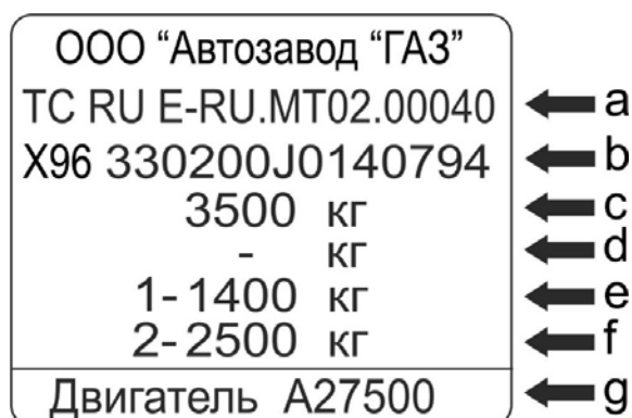
Рис. 1.4. Пример заводской таблички с паспортными данными, где: а – номер одобрения типа ТС или одобрения типа шасси;
