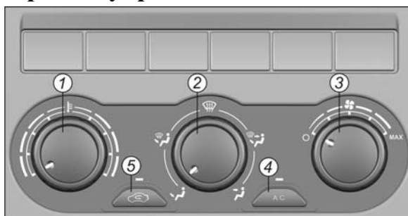
Рис. 8.5. Пульт управления отоплением, вентиляцией и кондиционированием воздуха
