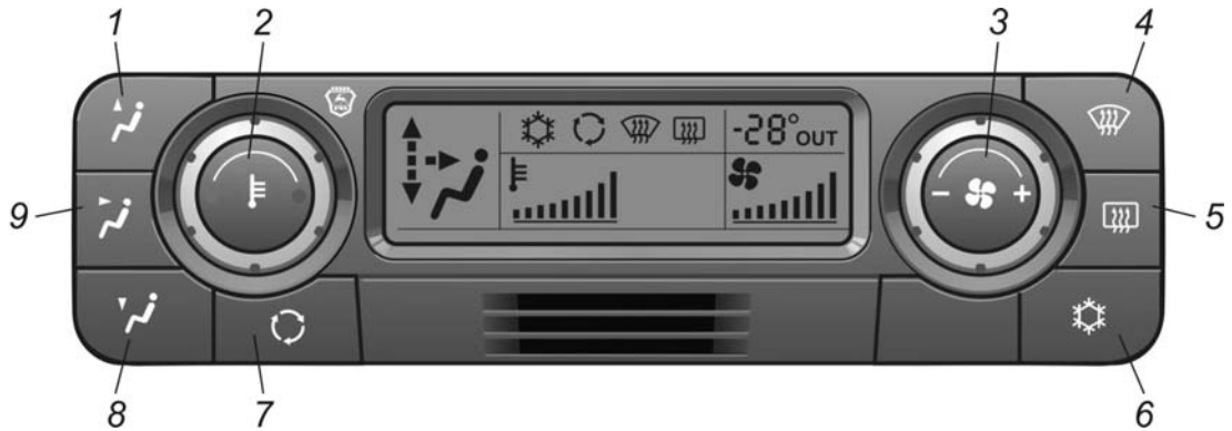
Рис. 8.1. Пульт управления отопительно-вентиляционной и климатической установкой
