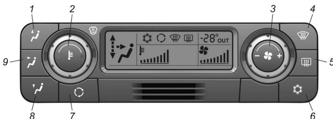
Рис. 8.1. Пульт управления отопительно-вентиляционной и климатической установкой
