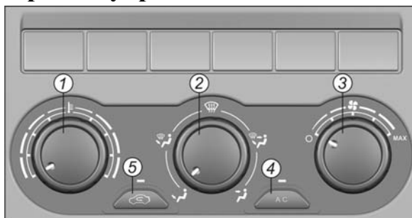
Рис. 8.6. Пульт управления отоплением, вентиляцией и кондиционированием воздуха
