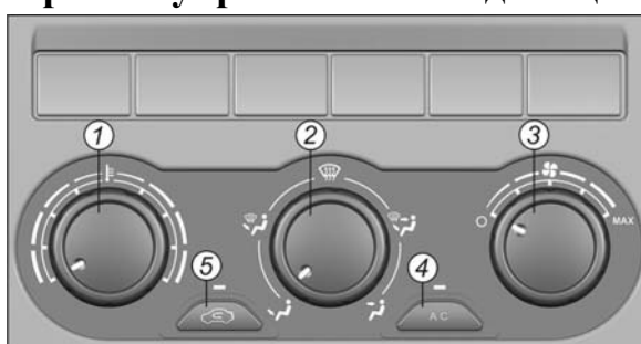
Рис. 8.6. Пульт управления отоплением, вентиляцией и кондиционированием воздуха
