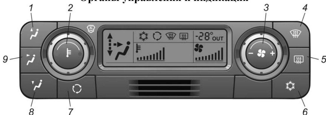
Рис. 8.1. Пульт управления отопительно-вентиляционной и климатической установкой
