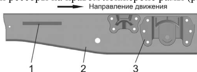
Рис. 1.3. 1 – место нанесения VIN автомобильных шасси для дооборудования коробкой отбора мощности; 2 – передний кронштейн задней рессоры; 3 – лонжерон рамы правый
