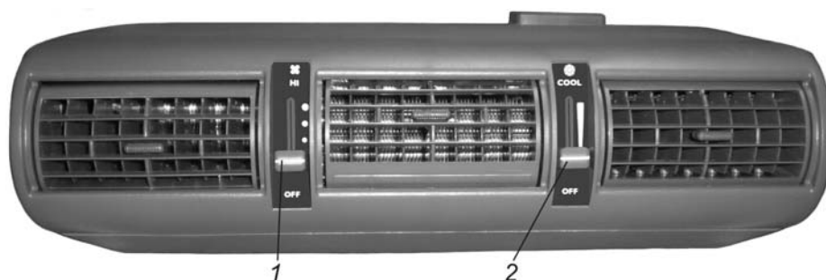
Рис. 8.4. Управление задним охладителем
