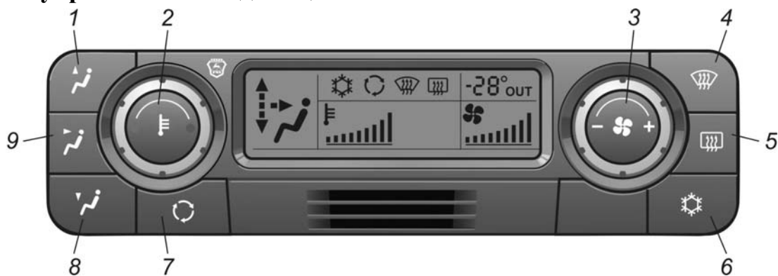
Рис. 8.1. Пульт управления отопительно-вентиляционной и климатической установкой
