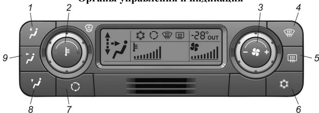
Рис. 8.1. Пульт управления отопительно-вентиляционной и климатической установкой
