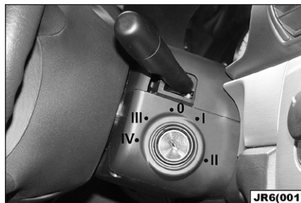
Положения ключа зажигания для автомобилей с автоматической коробкой передач
