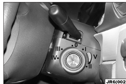
Положения ключа зажигания для автомобилей с механической коробкой передач
