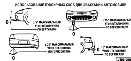
Скоба предназначена только для буксировки автомобиля с опорой на все колёса
