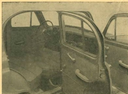
Рис. 18. Положение переднего сиденья при устройстве спальных мест в кузове
