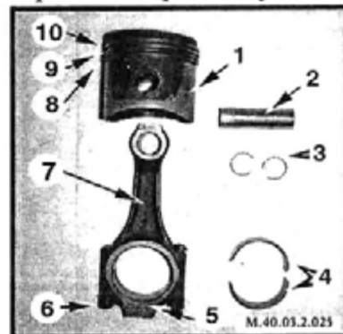
1. Поршень; 2. Поршневой палец; 3. Стопорные кольца; 4. Вкладыши; 5. Крышка шатуна; 6. Гайка крышки шатуна; 7. Шатун; 8. Канавка для маслоотводящего кольца; 9. Канавка для второго компрессионного кольца; 10. Канавка для верхнего компрессионного кольца.
