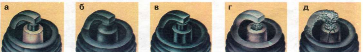
Рис.22. Виды износа свечей зажигания.
