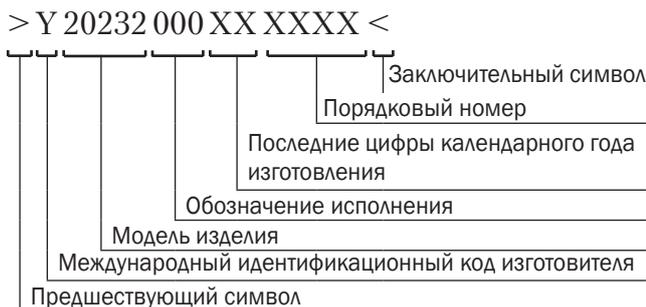
Рисунок 1.2 — Маркировочная табличка и расшифровка номера трактора АМКОДОР 20232
