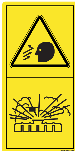
8. Наклейка с предупреждающей надписью о высоком давлении под крышкой радиатора - С левой стороны капота на лючке доступа к крышке радиатора.
