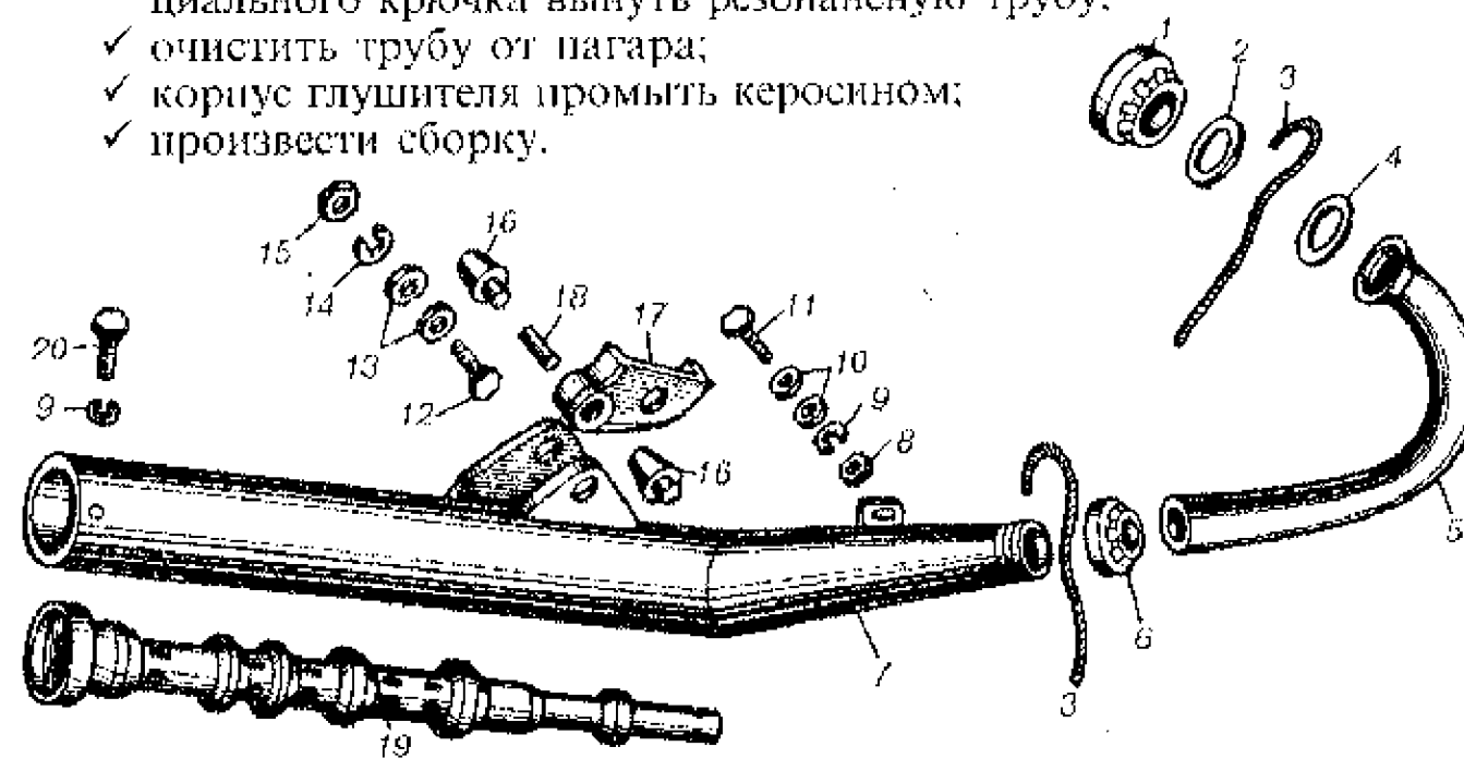
Рис. 3.15. Система выпуска газа мотоцикла "Восход-3М": 1 - гайка выпускной трубы; 2 - пайба; 3 - шнур уплотняющий; 4 - кольцо уплотнительное; 5 - труба выпускная; 6, 8, 15 - гайки; 7 - глушитель; 9, 10, 13, 14 - пайбы; 11, 12, 20 - болты; 16 - втулка; 17 - кронштейн; 18 - втулка распорная; 19 - труба резонансная
